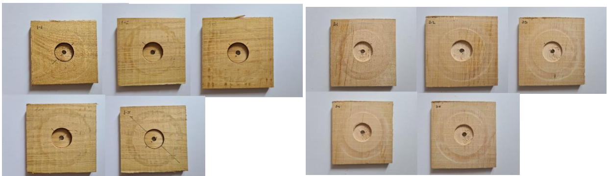
Slika 34 Uzorci bagrema i joha nakon taber testa [izvorno autor]
