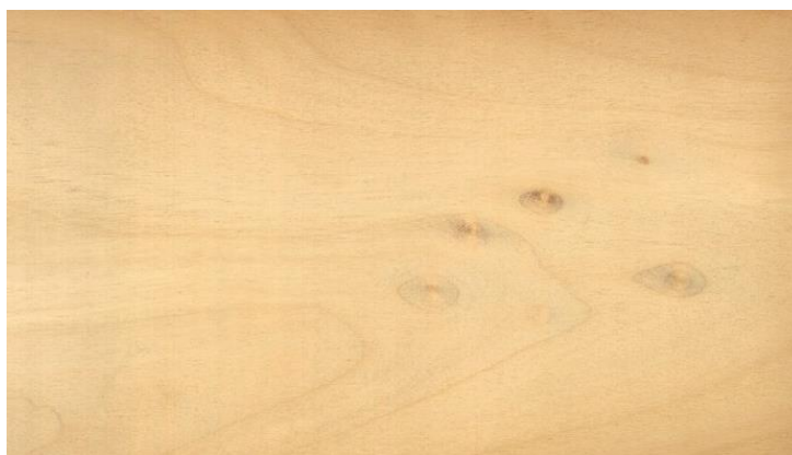
Slika 2 Tekstura obrađenog drva- topola [1]
