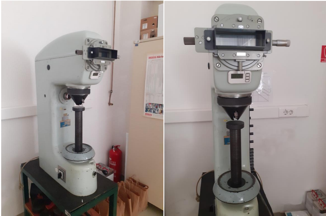
Slika 8 Uređaj za ispitivanje tvrdoće po Brinellu [izvorno autor]
