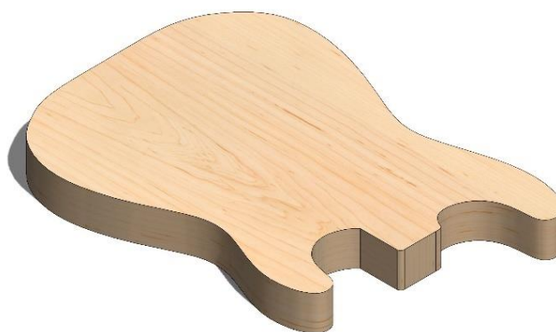
Slika 18 3D model tijela gitare: Prva skica izrade od drva [izvorno autor]
