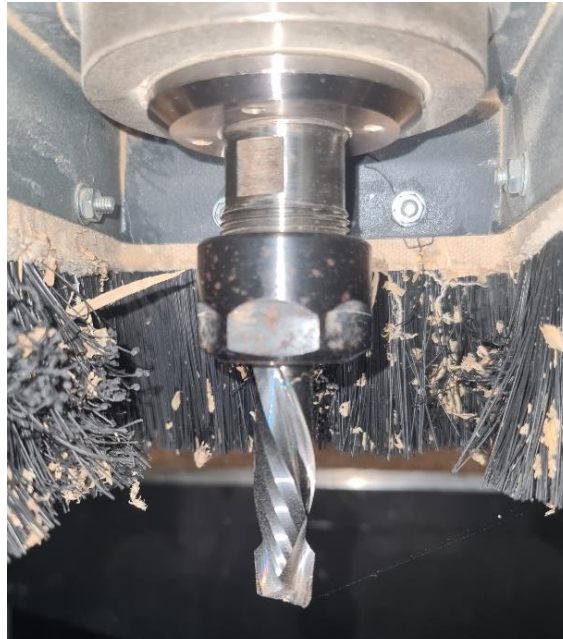
Slika 23 Glodalo za izradu kontura te udubina [izvorno autor]
