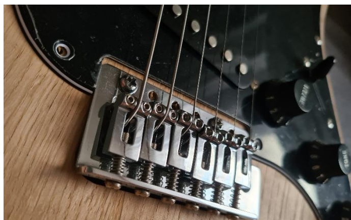
Slika 31 Postavljanje mosta gitare [izvorno autor]
