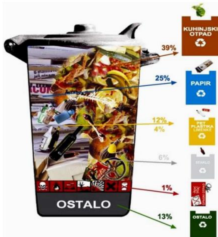
Slika 2. Prosječan sadržaj kućnog otpada [2]
