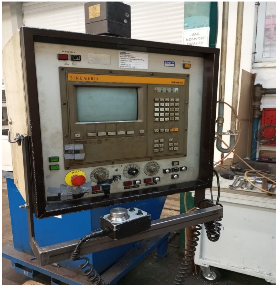
Slika 14. Numeričko upravljanje CNC tokarilice
