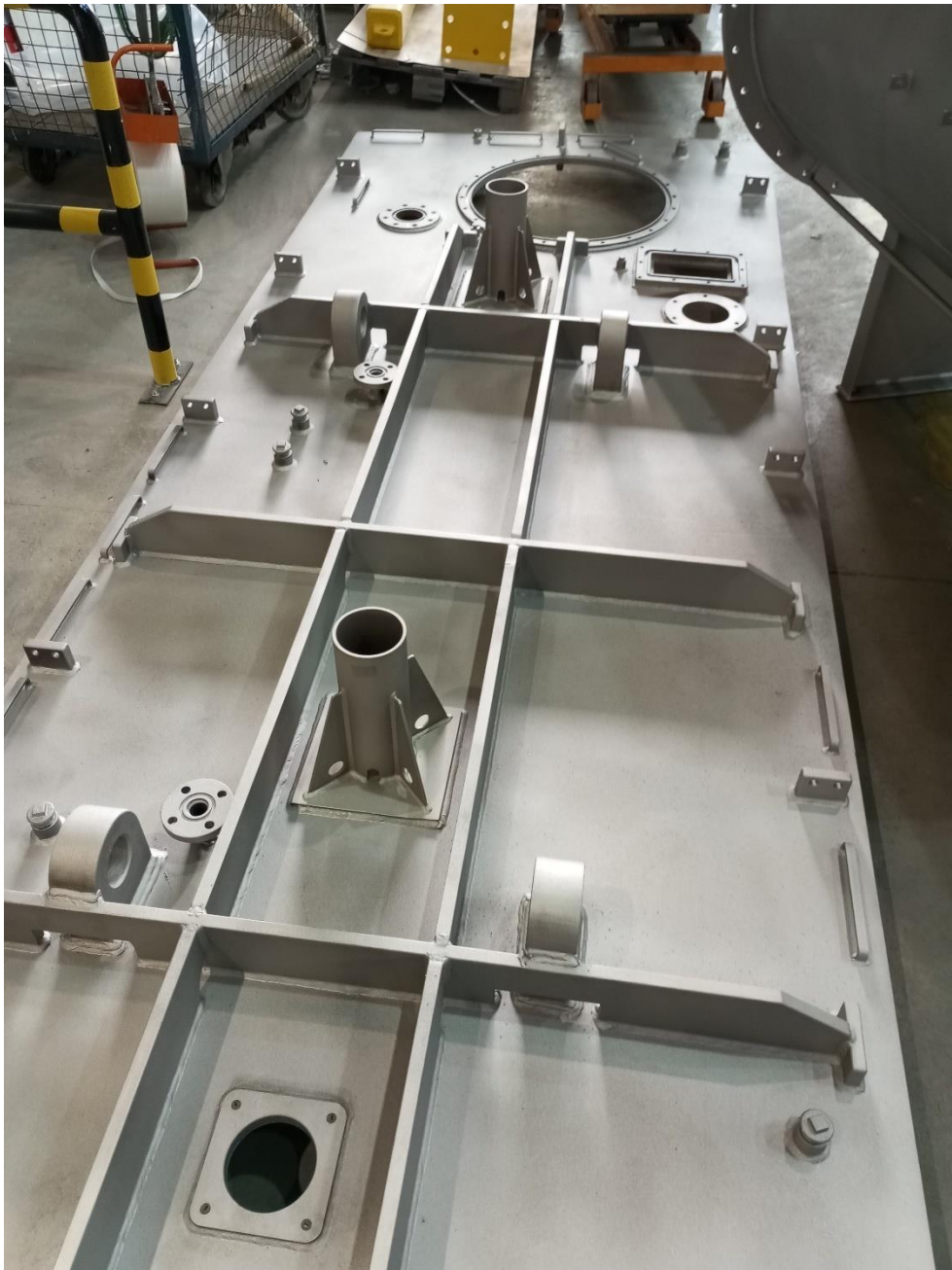
Slika 3. Poklopac transformatorskog kotla
