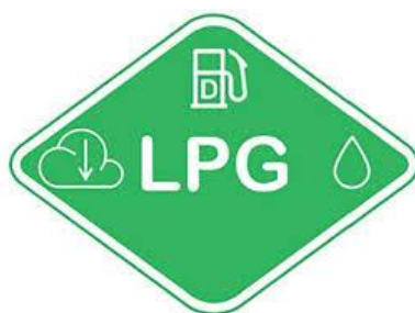
Slika 32. Oznaka vozila na ukapljeni naftni plin sukladno normi ISO 17840 [15]
