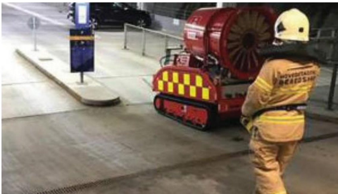
Slika 36. Korištenje „LUF 60“ za ventilaciju i vuču vozila iz podzemnih parkirališta ili parkirnih garaža [17]
