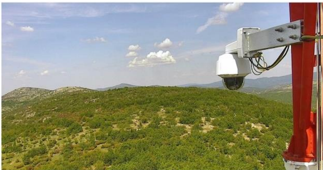
Sl. 16. Nadzorna video kamera STRIBOR sustava [16]
