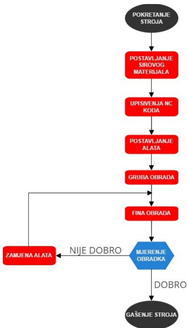
Slika 5. Dijagram toka kod procesa glodanja [6]
