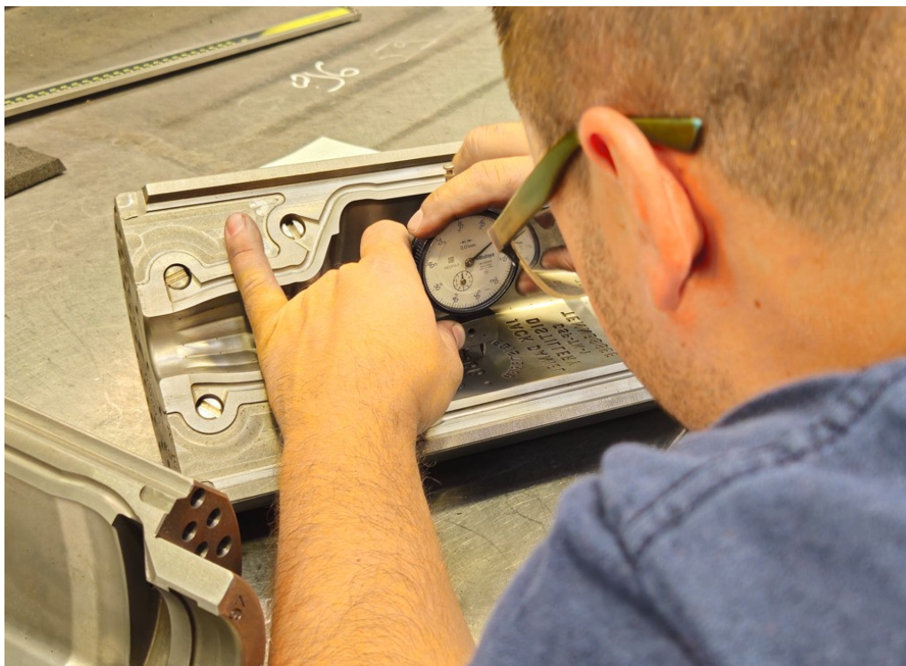
Slika 94. Mjerenje dubine gravure
