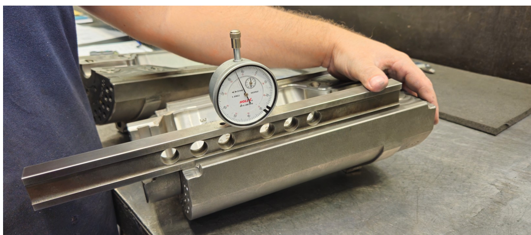
Slika 74. Mjerenje lećastog zazora na M.P
