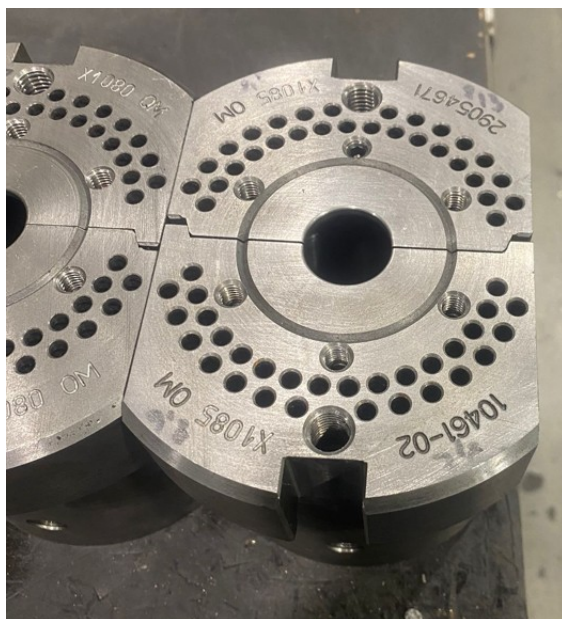
Slika 32. Vanjsko završno glodanje [11]
