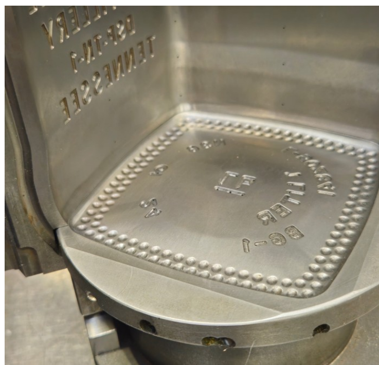
Slika 105. Vizualna kontrola spoja unutarnje stijenke kalupa i dna
