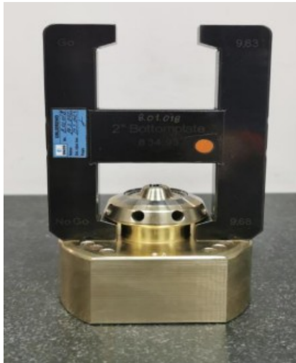
Slika 51. Postupak mjerenja kosine prizme na dnu kalupa [16]
