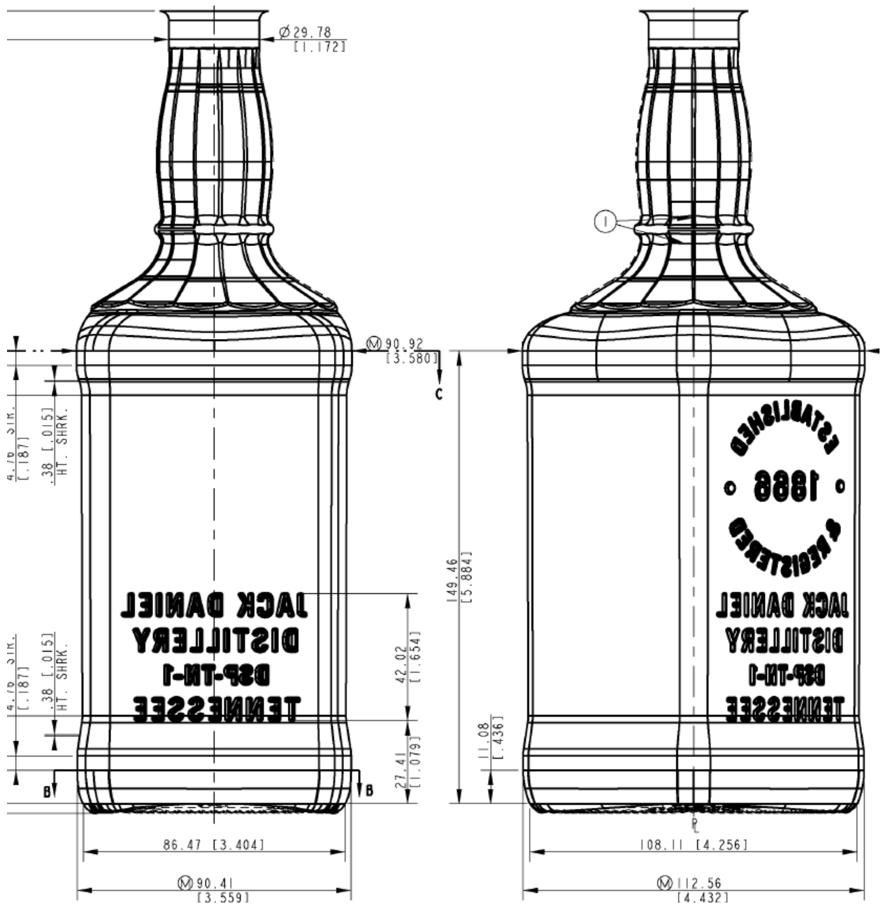
Slika 71. Mjere unutarnje stijenske kalupa na tehničkom crtežu
