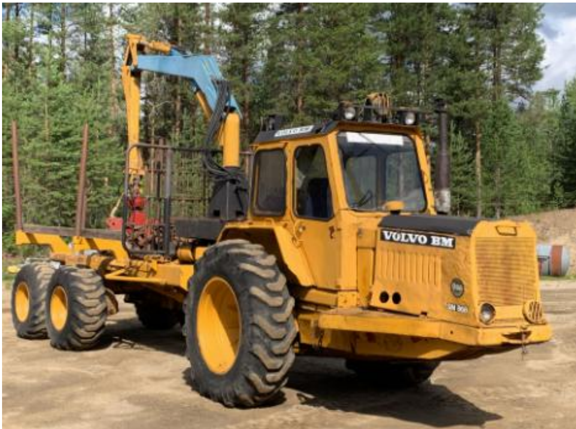
Slika 2. Forvarder Volvo BM [1]
