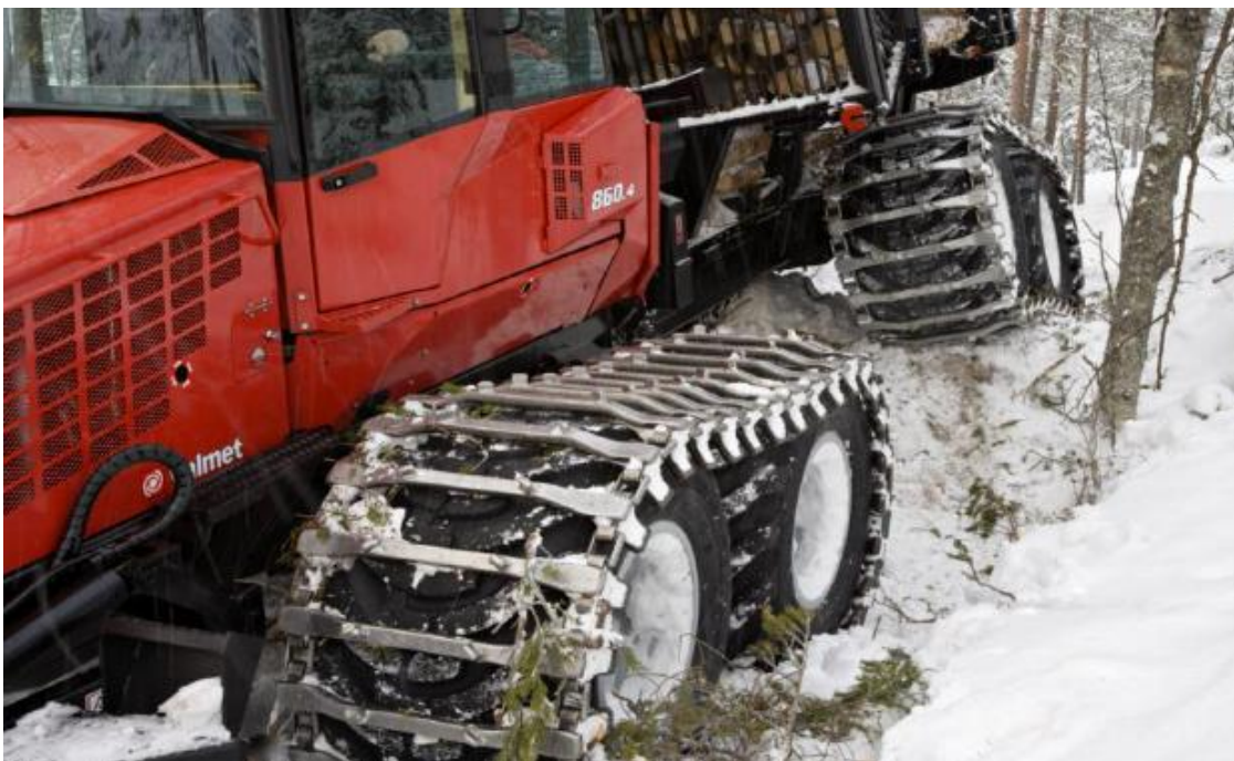
Slika 15. Polugusjenice montirane na forvarder [6]
