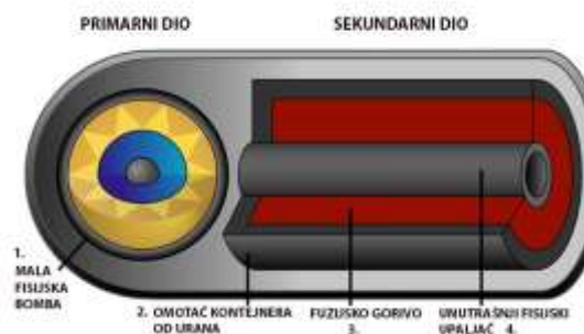
Slika 2: Unutarnji prikaz nuklearne fisije u H-bombi.
