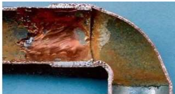
Slika 18. Erozijsko – korozijsko oštećenje bakrenog cjevovoda – oštećenja su usmjerena u smjeru protoka medija. [1]
