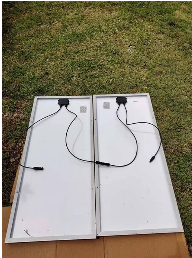
Slika 20. – Fizički prikaz solarnih panela spojenih u seriju
