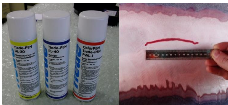
Slika 2.2. Ispitivanje penetrantima: razvijlač, čistač i penetrant (lijevo) penetrantska indikacija (desno)
