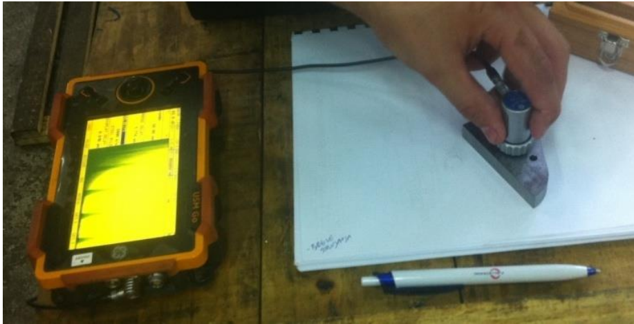
Slika 11.8. Baždarenje sonde na BD= 12.5 mm MP=50mm
