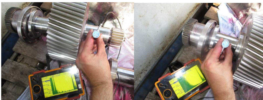
Slika 11.10. Ispitivanje ležajnih rukavaca kod pogonskog zupčanika
