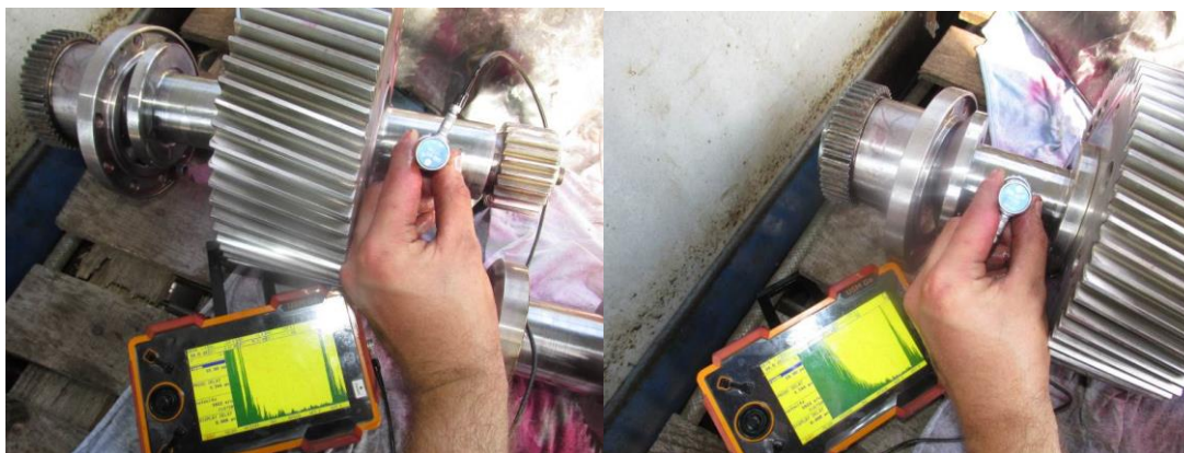
Slika 11.10. Ispitivanje ležajnih rukavaca kod pogonskog zupčanika
