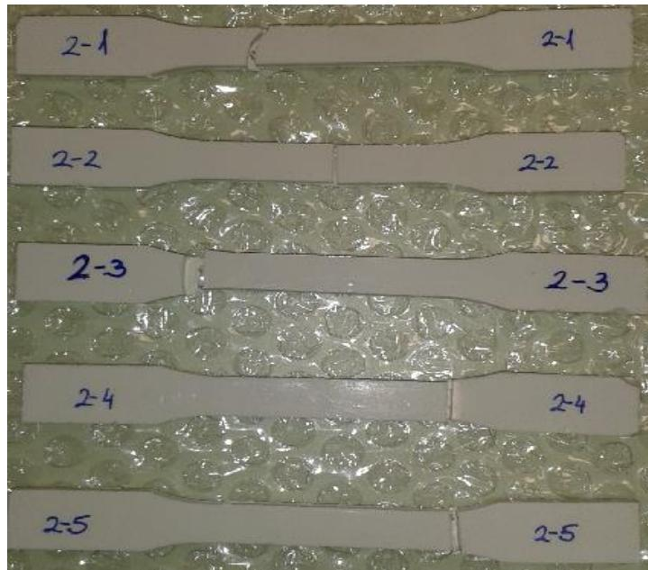
Slika 59. Akril ojačan staklenim vlaknoma nakon ispitivanja
