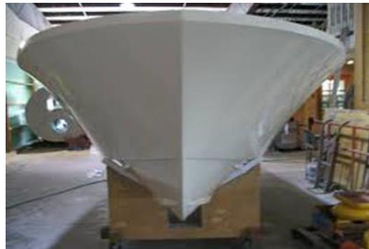
Slika 12. Trup glisera od polimernog kompozita [2]
