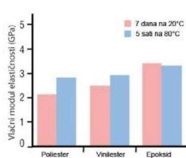
Slika 20. Usporedba vlačnog modula [13]
