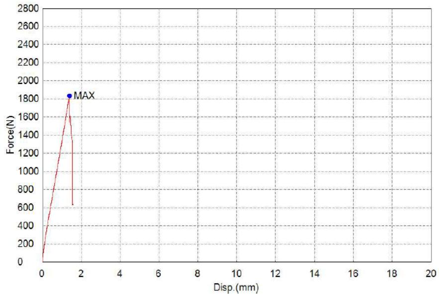
Slika 62. Dijagram vrijednosti ispitivanja vlaknima ojačanog kompozita 2\_2
