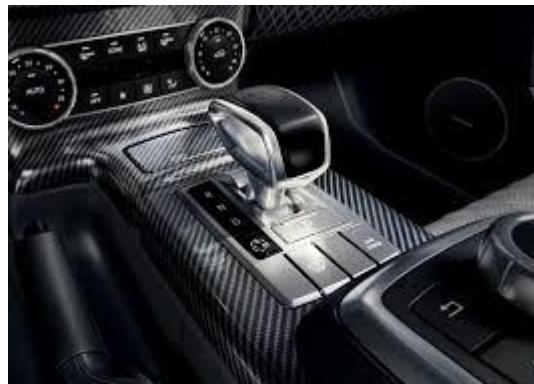
Slika 32. Unutrašnjost automobila od karbonskih vlakana [ 2]
