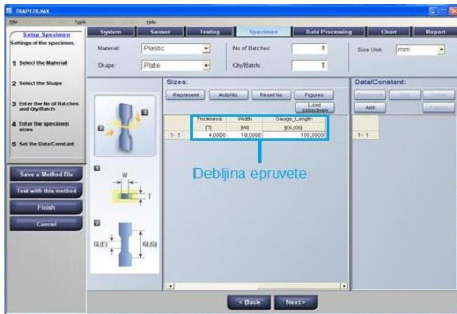
Slika 55. Odabir dimenzije epruvete
