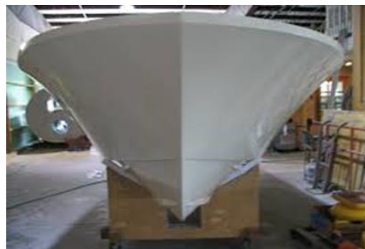
Slika 12. Trup glisera od polimernog kompozita [2]
