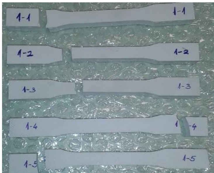
Slika 58. Astone nakon puknuća
