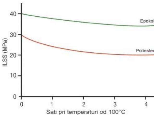
Slika 23. Dijagram svojstva kompozitnih laminata nakon uranjanja u vodu pri 100°C [13]
