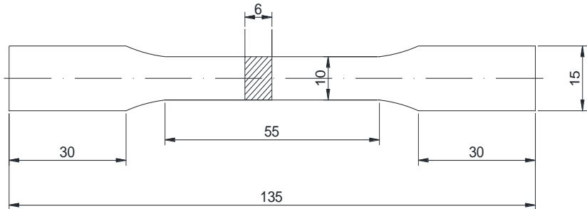
Slika 47. Epruveta od akrila ojačanog staklenim vlaknima
