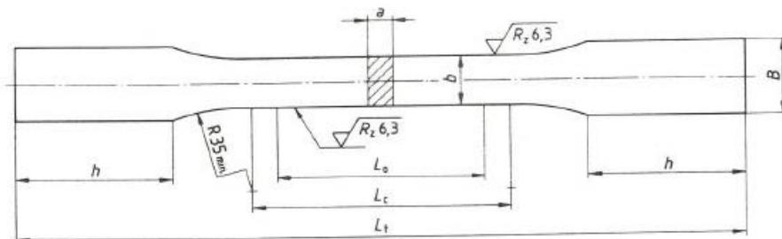
Slika 45. Epruveta izrađena standardom DIN 50 125
