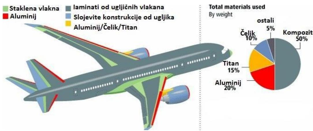
Slika 35 . Materijali korišteni na zrakoplovu Boeing 787 Dreamliner [2]
