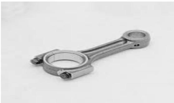
Slika 13 .Klipnjača motora [2]
