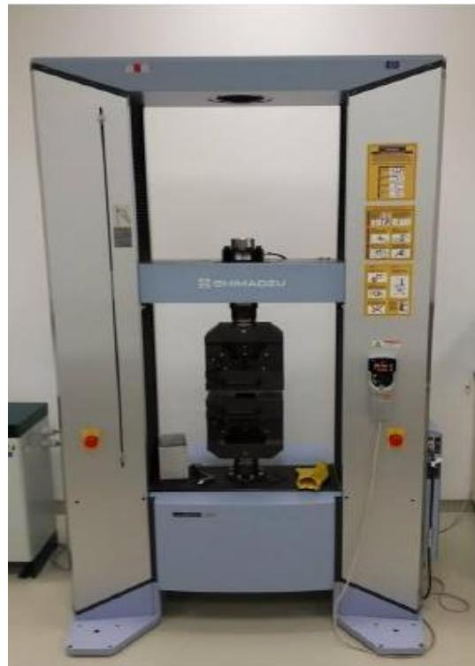
Slika 44. Kidalica SHIMADZU AG-X
