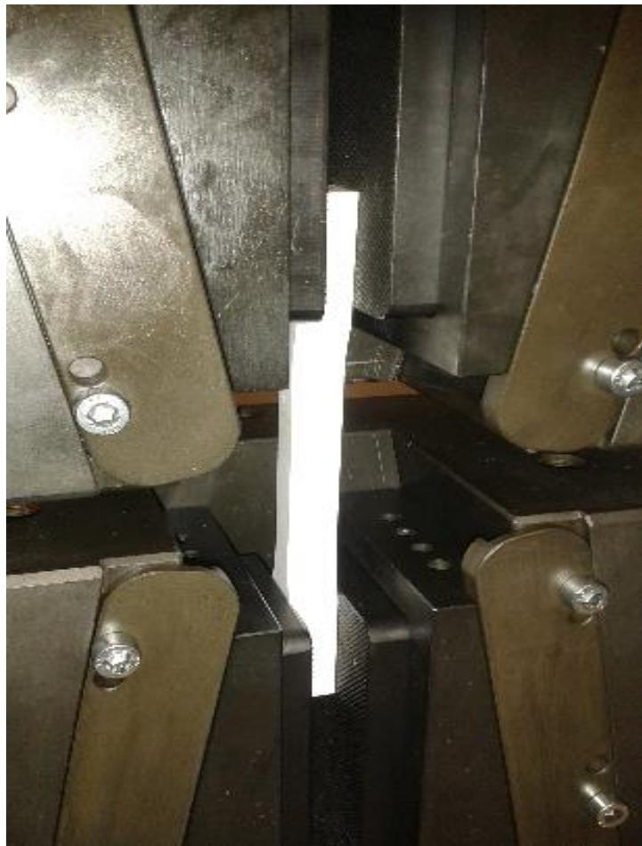
Slika 57. Pravilno postavljanje epruvete
