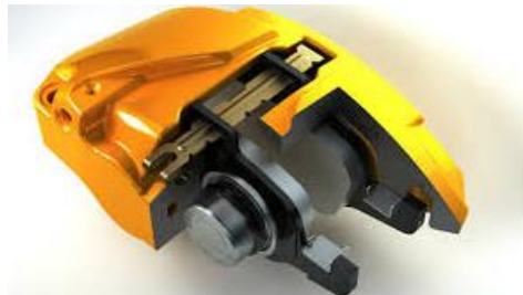
Slika 16. Koćiona klješta od keramike [2]
