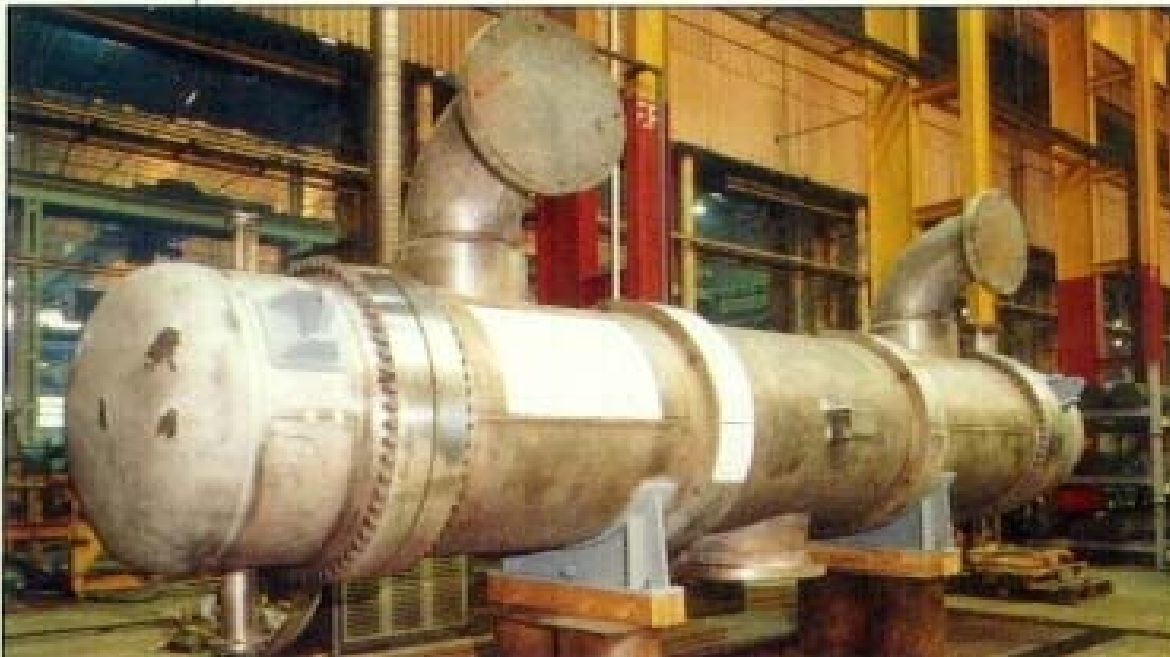
Slika 48. Gotova konstrukcija „Shell and tube“ izmjenjivača topline
