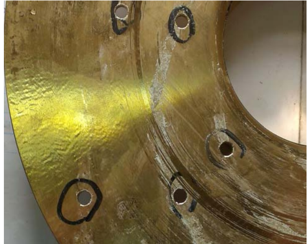
Slika 47. Zabušivanje diska s unutarnje strane
