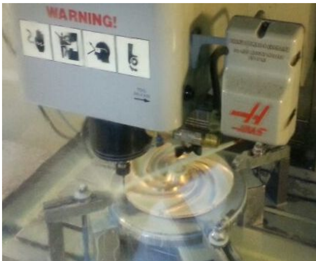
Slika 37. Obrada stražnjeg diska na CNC-u
