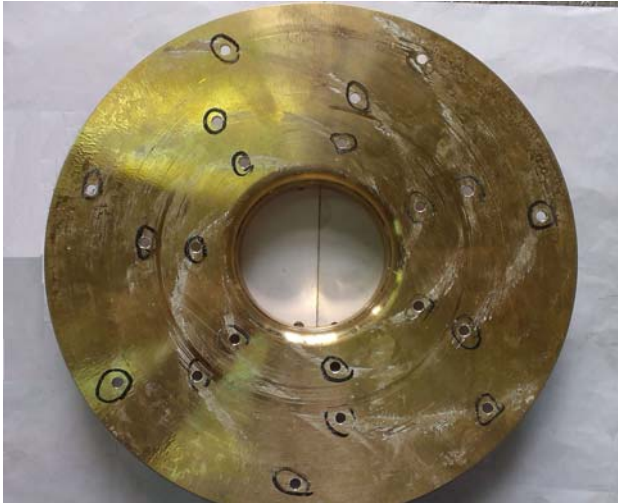
Slika 46. Zabušivanje diska s unutarnje strane
