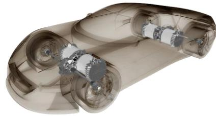
Slika 3.10. Diferencijal i ektromotor u sklopu ovjesa kotača, Concept One, Rimac automobili.
