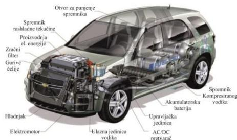
Slika 4.3. Shema sistema rada vozila na vodik.
