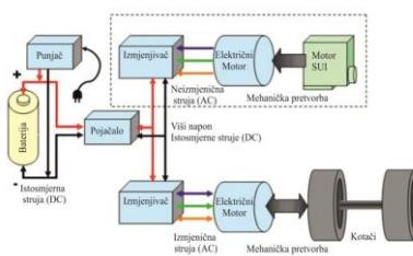
Slika 3.1. Shema rada električnog vozila.
