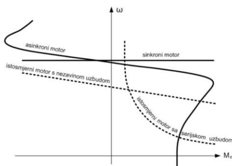
Slika 3.6. Vanjske karakteristike različitih tipova elektromotora.
