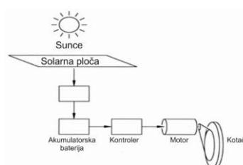
Slika 4.5. Princip rada sunčeva vozila.
