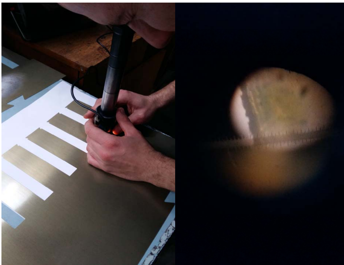
Slika 25. Mjerenje veličine srha optičkim srhomjerom s prikazom veličine srha [9]
