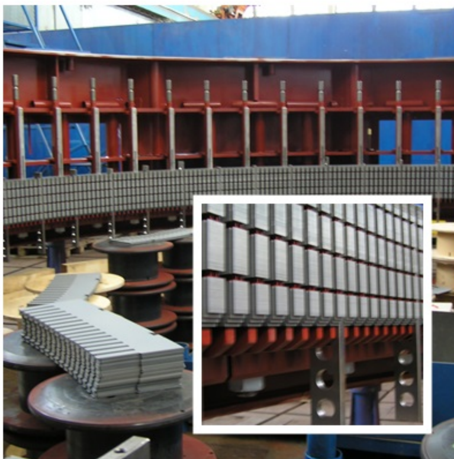
Slika 3. Primjer paketa statora u izradi (5 dionih paketa) [9]
