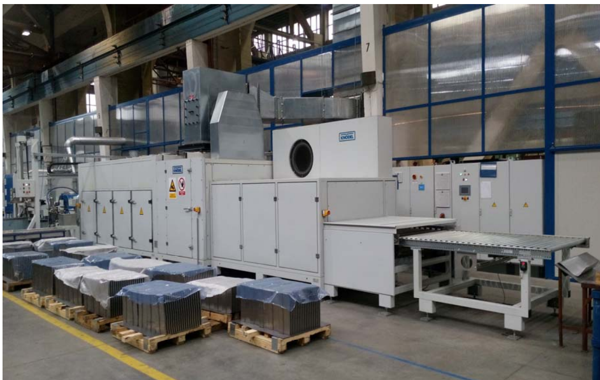
Slika 28. Linija za lakiranje „GENERAL“ u tvornici Končar GiM-a [9]
