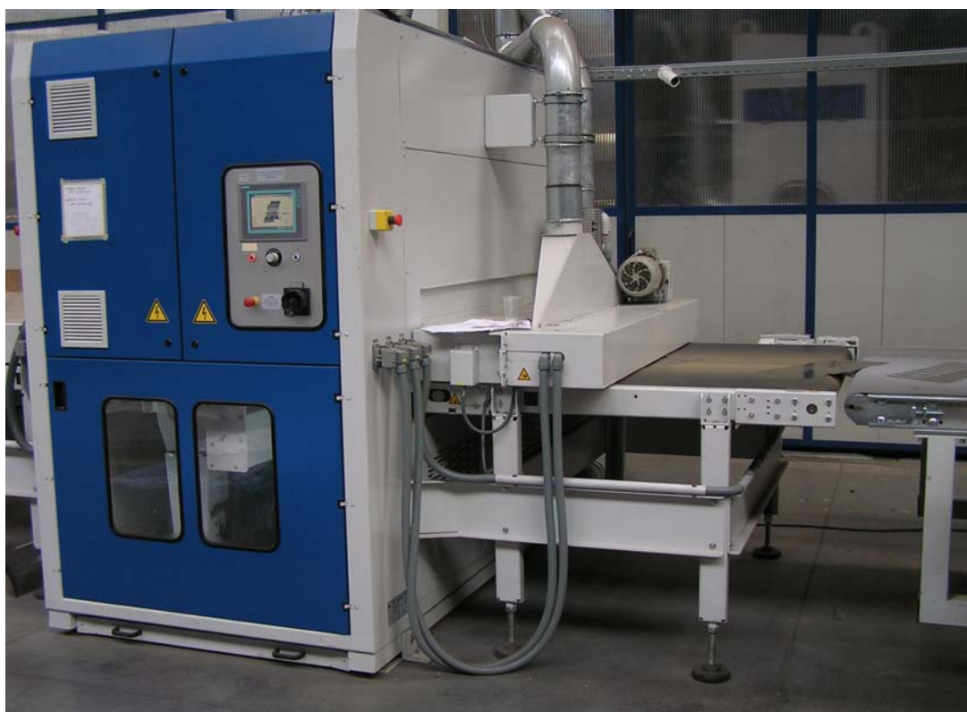
Slika 26. Proces skidanja srha s limova na brusilici MO/D-1300 [9]
