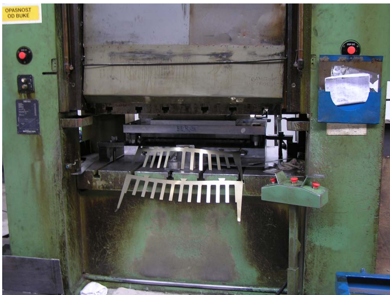
Slika 23. Prikaz štance na preši Metalna DRS – V125 [9]
