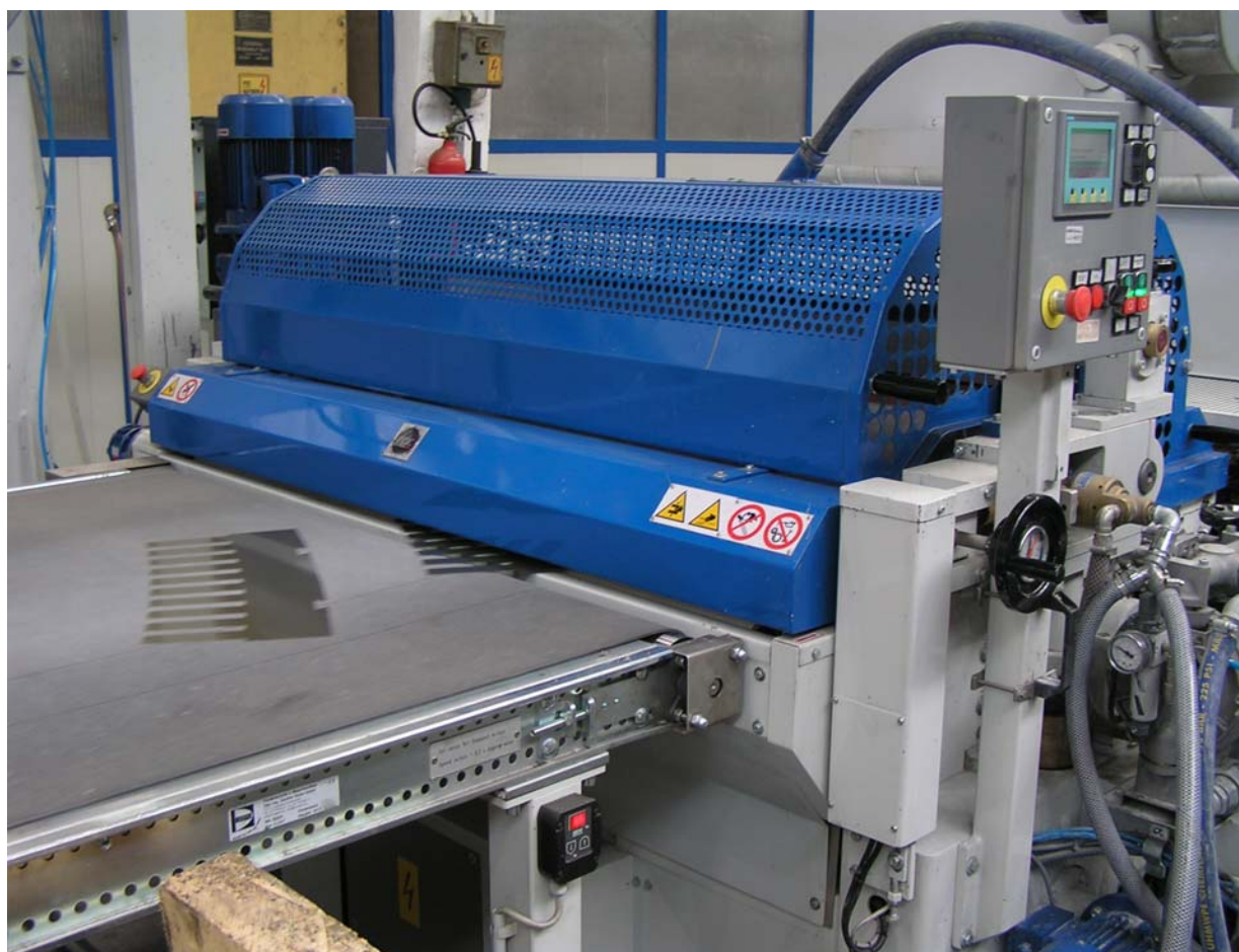
Slika 29. Uređaja za nanošenje laka (Tomanin) [9]
