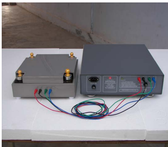
Slika 21. Jezgra i kontrolna jedinica Epstein aparata [14]
