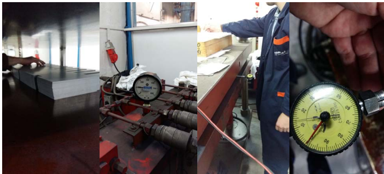
Slika 32. Slaganje limova u prešu, tlačenje limova, i mjerenje rastojanja ploča preše [9]
