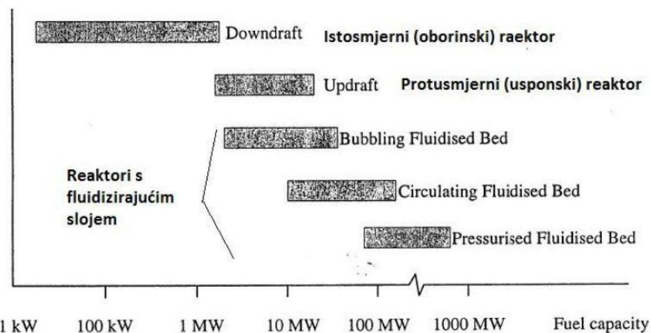
**Slika 19. Vrste reaktora ovisno o radnom kapacitetu**
