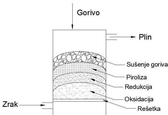
**Slika 22. Karakteristike protusmjernog rasplinjača**
