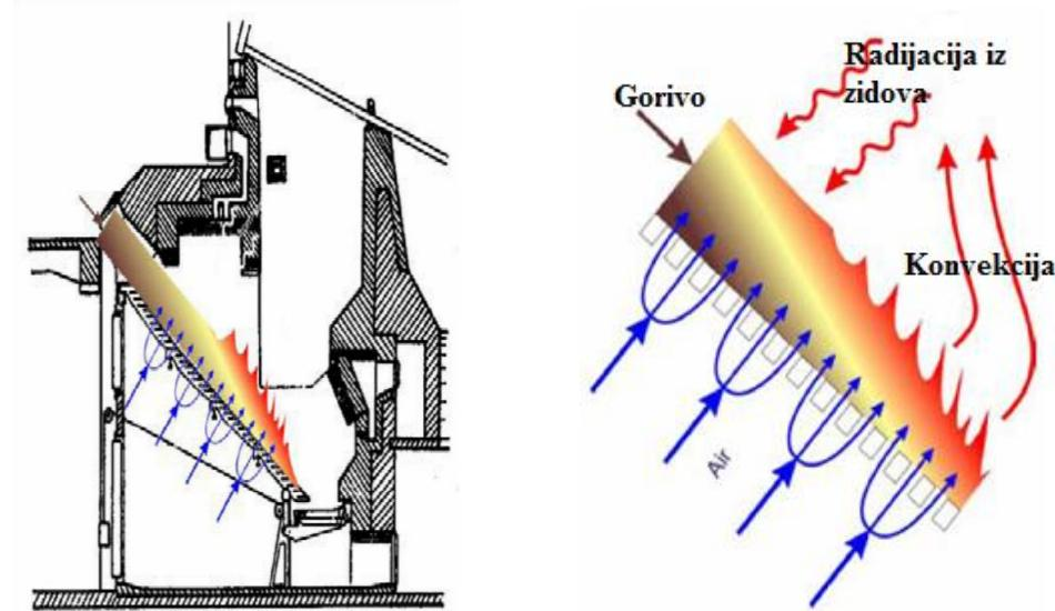
**Slika 11. Shematski prikaz procesa izgaranja na nagnutoj rešetki**
