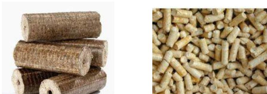
Slika 2. Briketi (lijevo) i peleti (desno)
