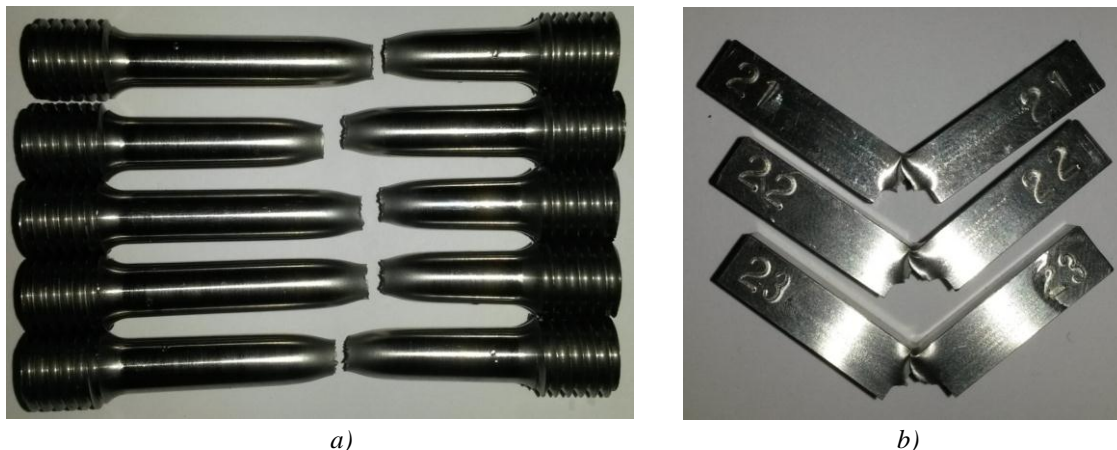
Slika 45 – Uzorci iz materijala Č4570 nakon: a) statičkog vlačnog pokusa b) udarnog rada loma
