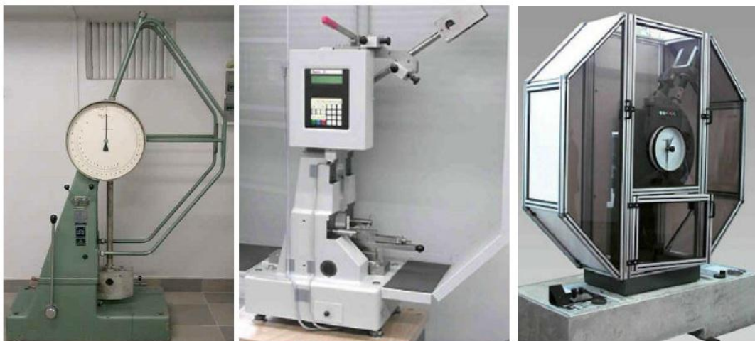
Slika 22 – Primjeri uređaja Charpy-evog bata [13]
