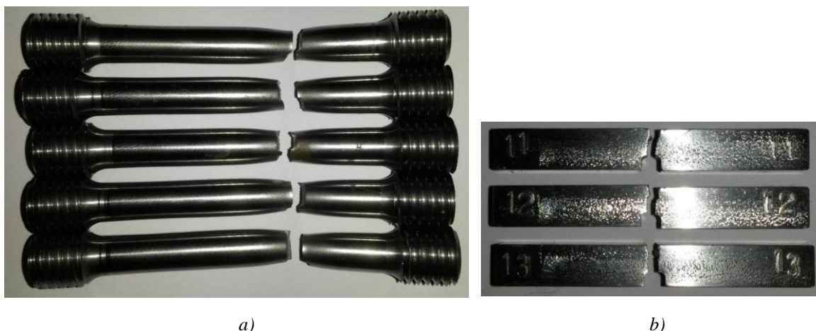
Slika 43 – Uzorci iz materijala Č4141 nakon: a) statičkog vlačnog pokusa b) udarnog rada loma
