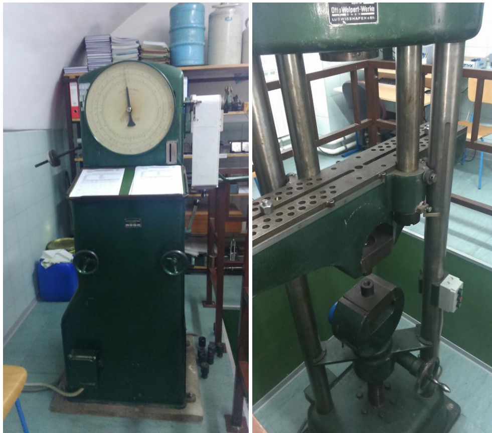
Slika 38 – Univerzalna hidraulička kidalica Tip U-60
