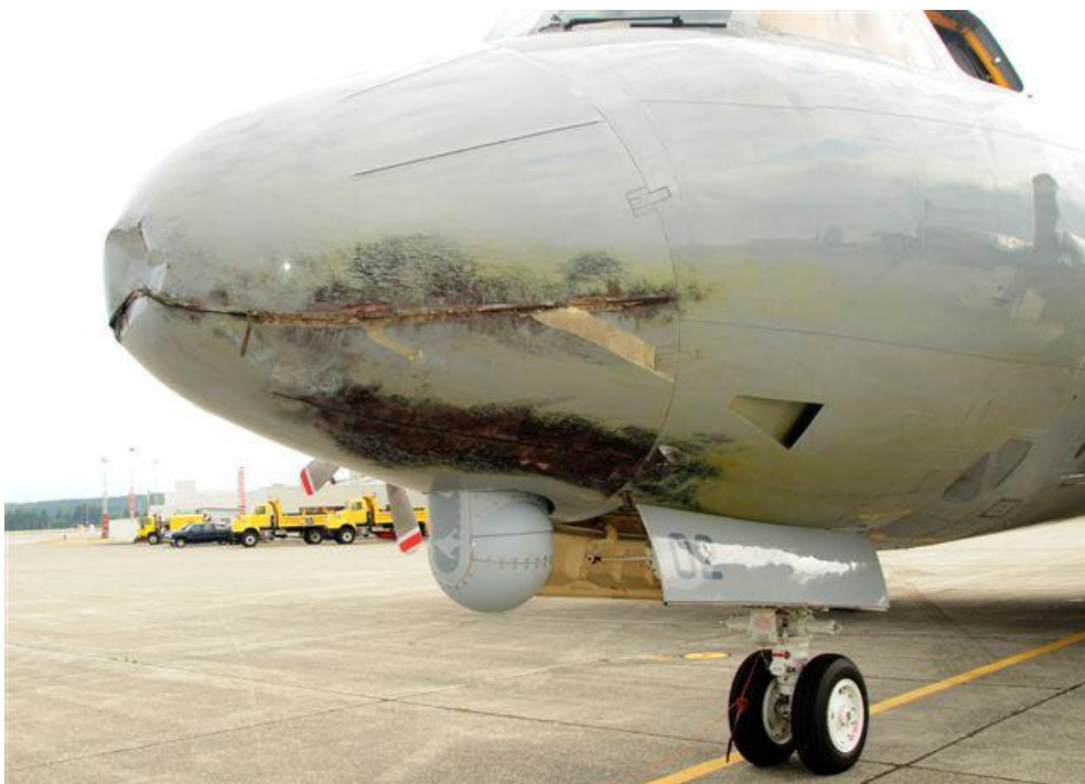
Slika 19. Oštećenje na zrakoplovu nakon udara munje [21]
