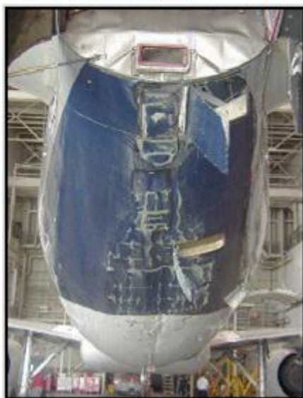
Oštećenje repa zrakoplova
