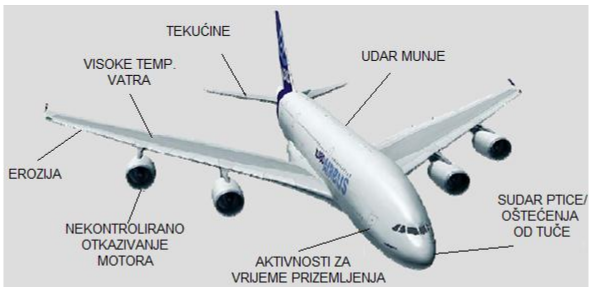
Slika 38. Uzroci oštećenja zrakoplovne konstrukcije
