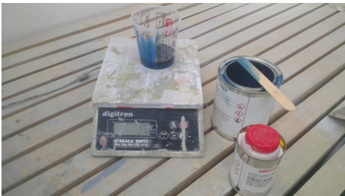
Slika 64. Miješanje smole i otvrdjivača
