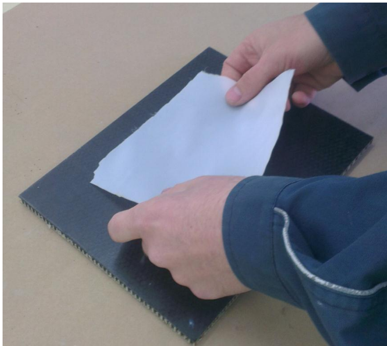
Slika 73. Nanošenje abrazivne tkanine
