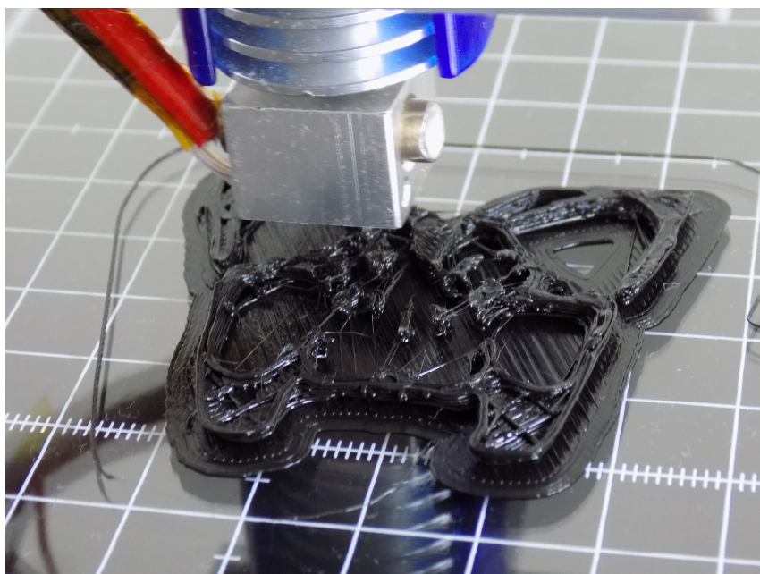
Slika 51. Prikaz izrade zadanog modela na FDM uređaju
