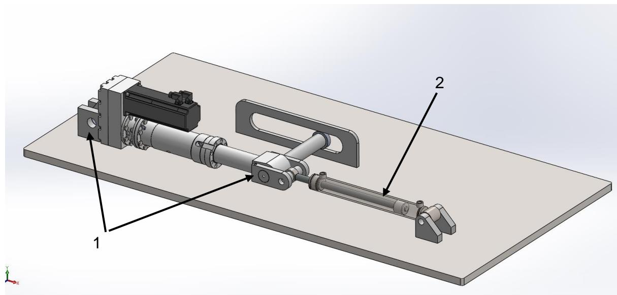
Slika 8 - 3D model naprave za ispitivanje aktuatora
