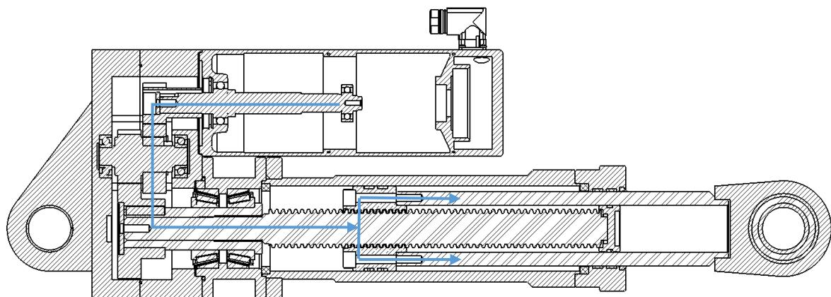
Slika 6 - Prijenos momenta kroz sklop aktuatora
