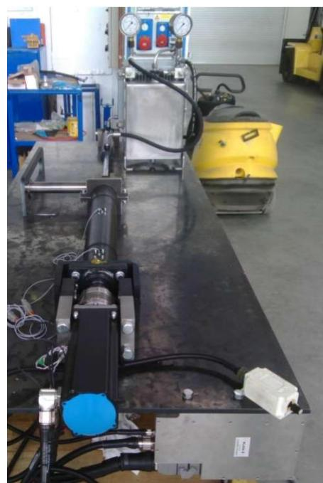
Slika 10 - Ispitivanje aktuatora
