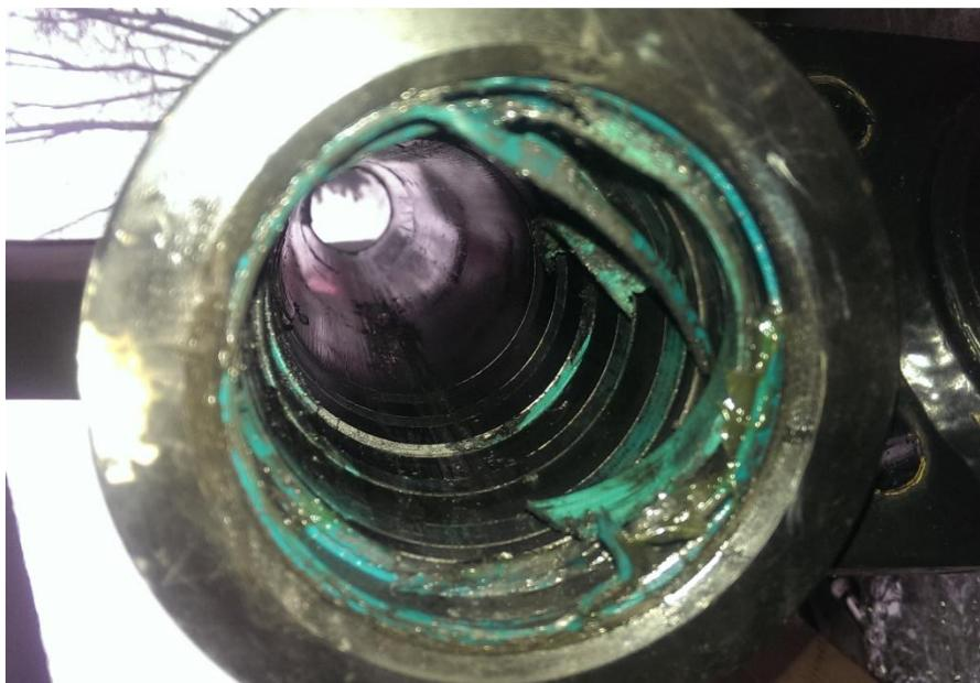
Slika 5 - Oštećenje na cilindru aktuatora
