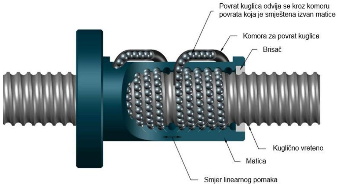
Slika 51 - Kuglično vreteno - presjek
