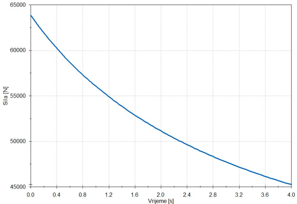
Slika 16 - Sila na aktuatoru u ovisnosti o vremenu
