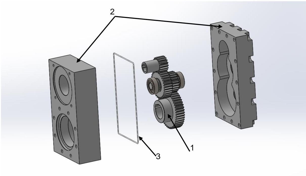
Slika 4 - Sklop reduktora
