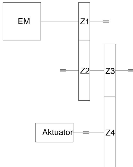
Slika 49 - Reduktor s konzolno opterećenim zupčanicima
