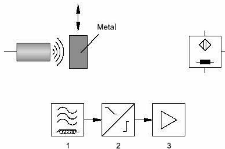
Slika 40 - Induktivni senzor
