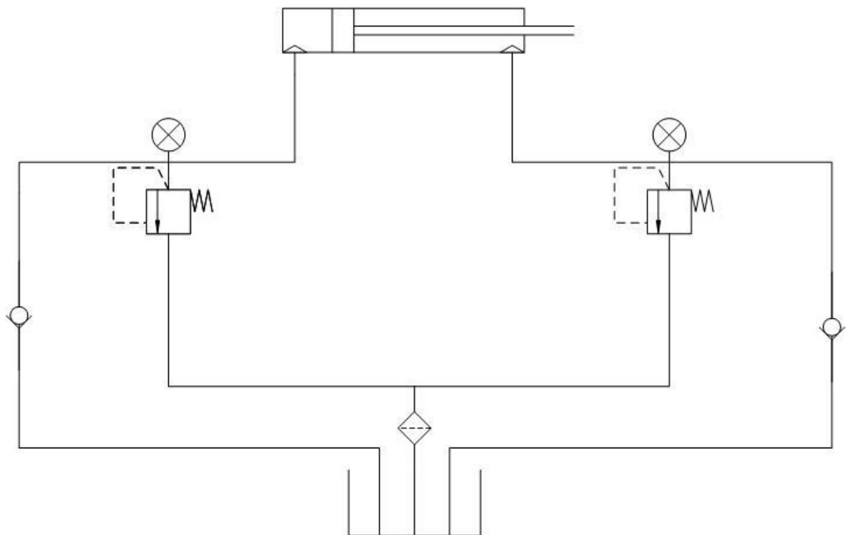
Slika 11 - Hidraulički dijagram naprave za testiranje aktuatora
