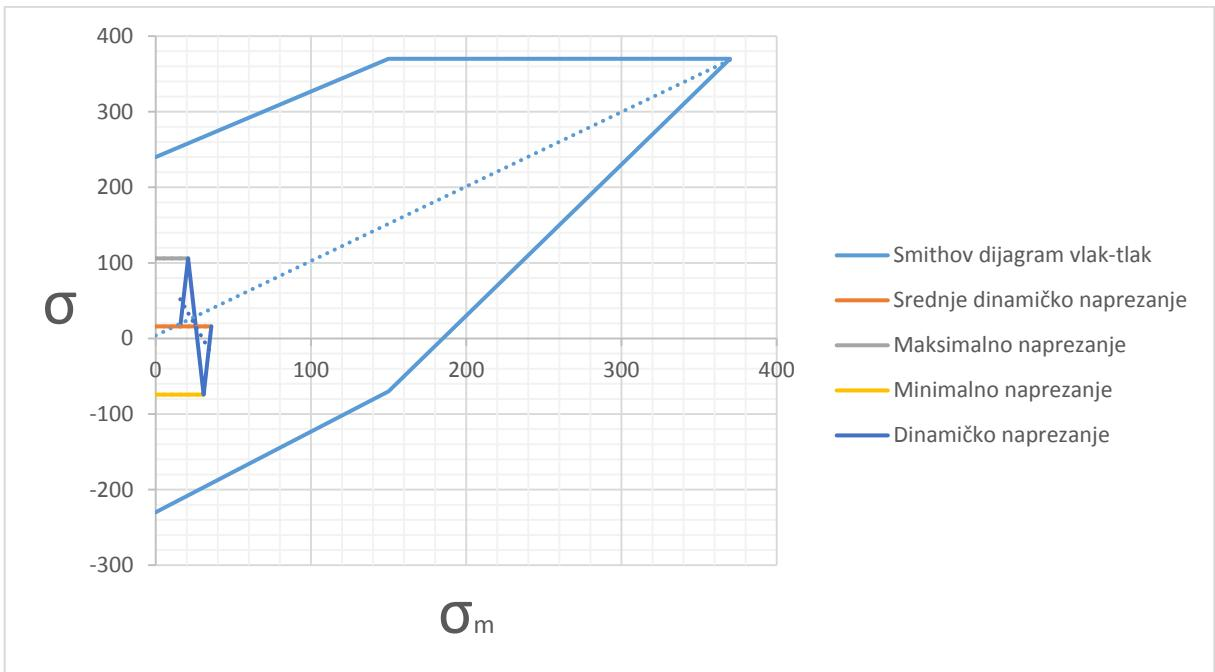
Slika 26 - Smithov dijagram s dinamičkim naprezanjem na vretenu
