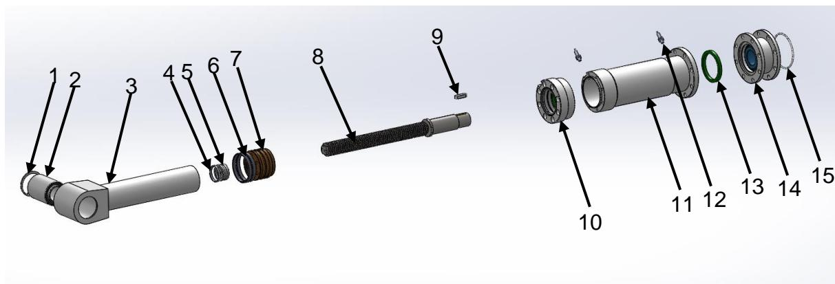
Osnovni dijelovi sklopa cilindar-klip aktuatora:
