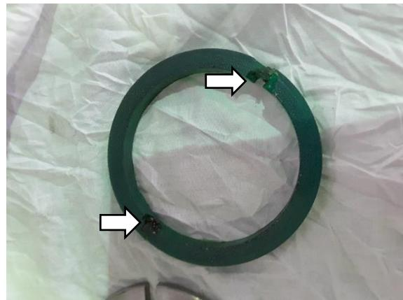
Slika 46 - Oštećenja na polimernom graničniku
