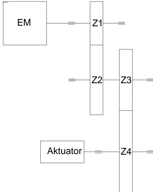
Slika 50 - Shema reduktora bez konzolno opterećenih zupčanika
