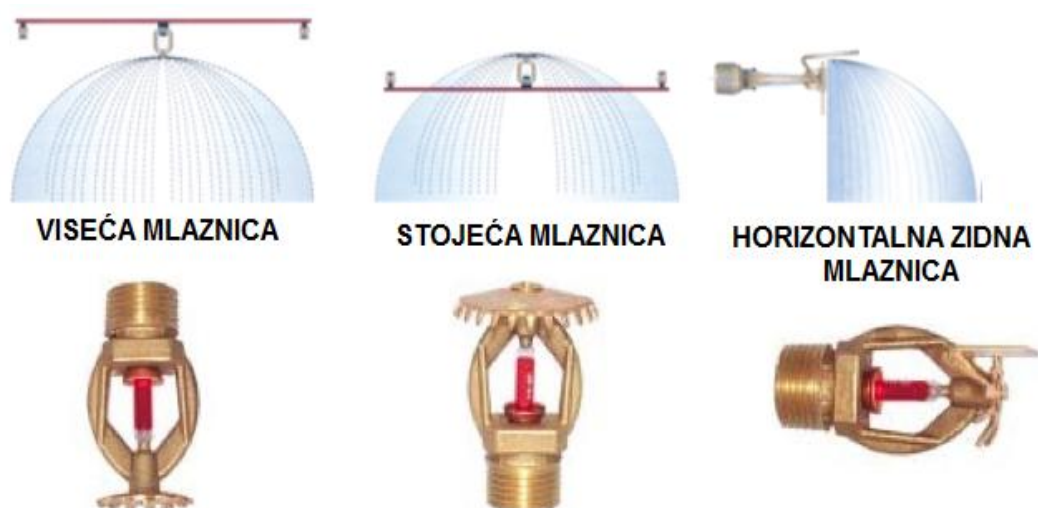
Slika 39. Predodžba različitih tipova ugradnje sprinkler mlaznica
