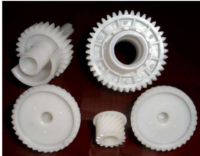
Slika 34. Izrada zupčanika od polioksimetilena[23]
