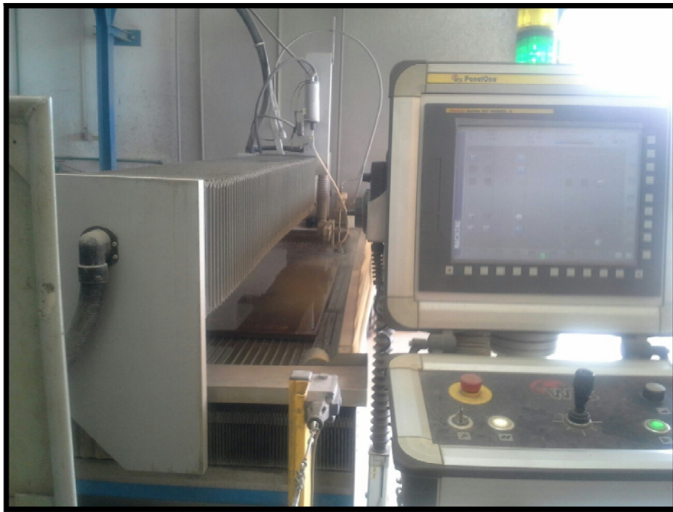
Slika 9.1. Izrezivanje prirubnica na stroju NC 3015 EB
