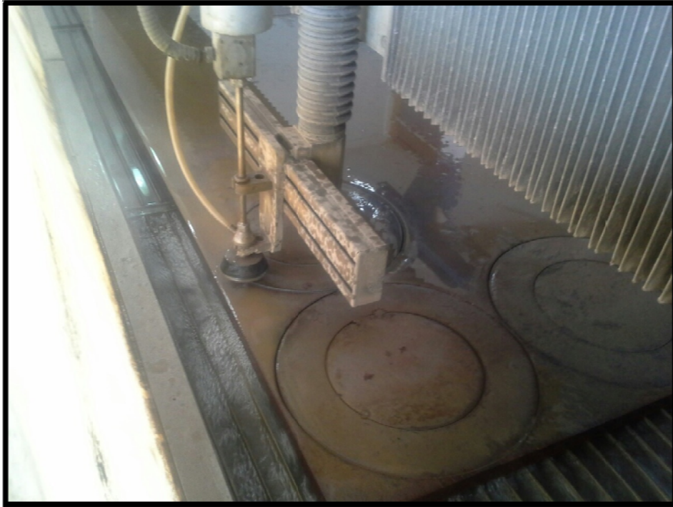
Slika 9.2. Izrezivanje prirubnica na stroju NC 3015 EB
