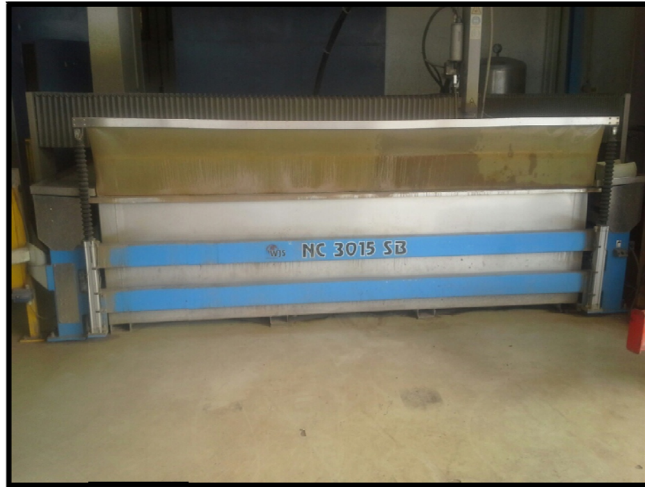
Slika 9.4. Stroj za rezanje vodenim mlazom NC 3015 EB
