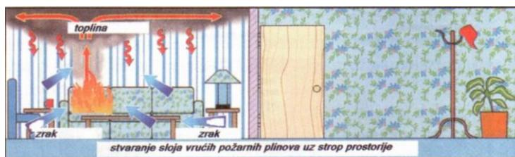
Slika 1. Povišenje temperature u prostoriji ovisno o temperaturi požarnih plinova [1]
