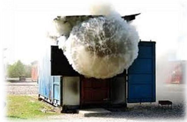
*Slika 5. Backdraft stvoren u simulatoru plamenih udara [6]*
