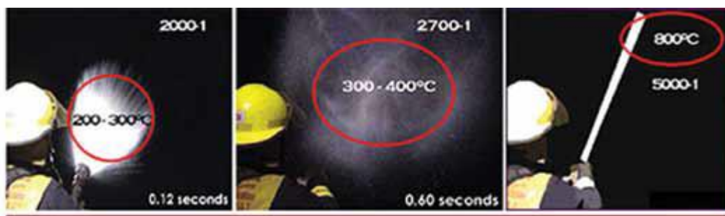
Slika 18. Odnos veličine kapljica vode i volumena stvaranja vodene pare [7]
