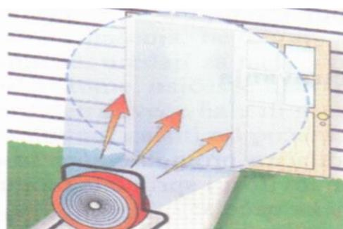
Slika 35. Postavljanje nadvlačnog ventilatora [1]
