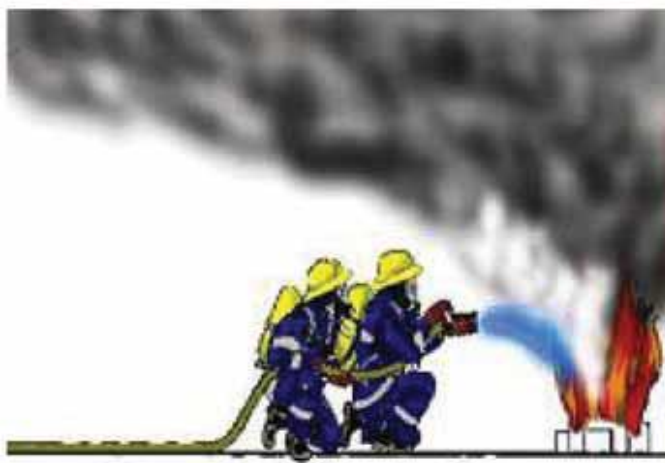
Slika 21. Postava mlaza kod „pulsirajuće” tehnike polijevanjem [7]
