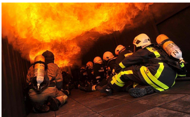
Slika 16. Flashover u simulatoru na kruta goriva [6]
