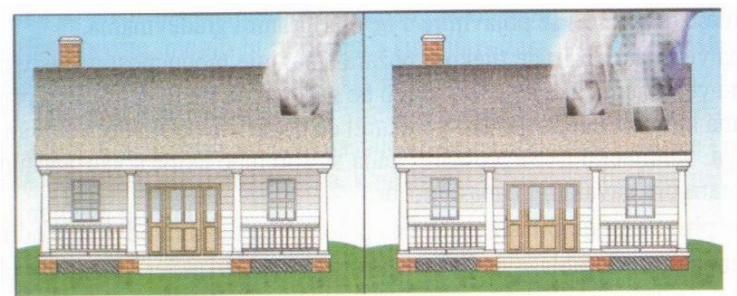
*Slika 28. Ventilacijski otvor na krovu [1]*
