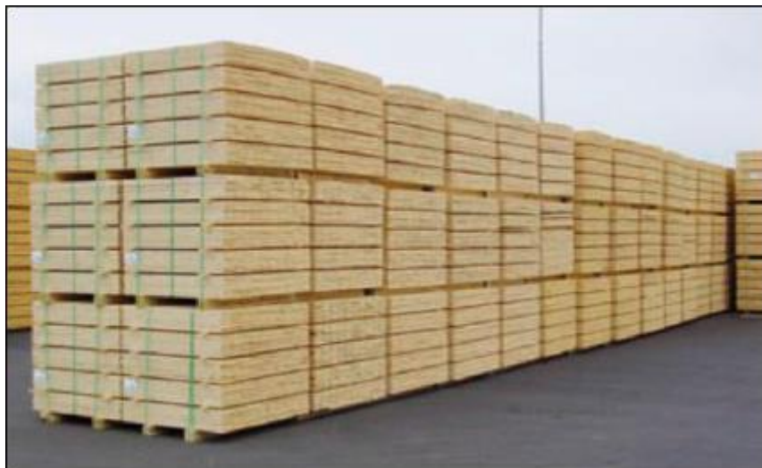
Sl. 24. Dobro složena i zapakirana drvena građa [1]
