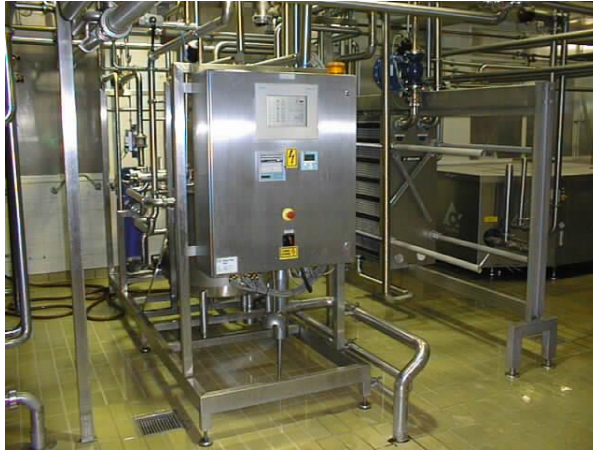
Slika 8 Linija za pasterizaciju i homogenizaciju
