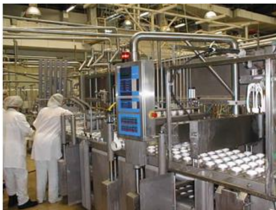
Slika 9. Linija za proizvodnju sladoleda
