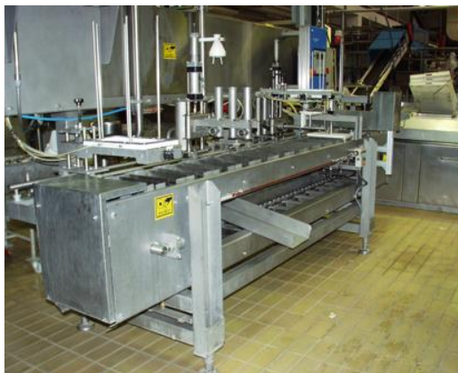
Slika 10 linija za proizvodnju sladoleda u kadicama
