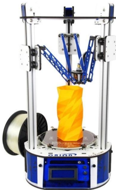
Slika 24. Način izrade modela na delta printeru [22]
