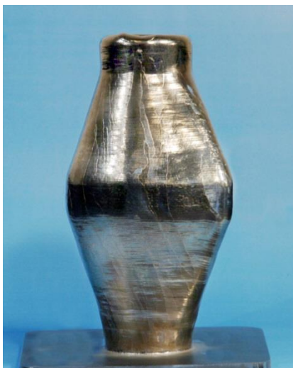
Slika 14. Model nastao metodom elektronskog snopa sa žicom [14]
