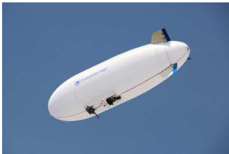
Sl. 16. Radiometrijski senzor na bespilotnom cepelinu [6]
