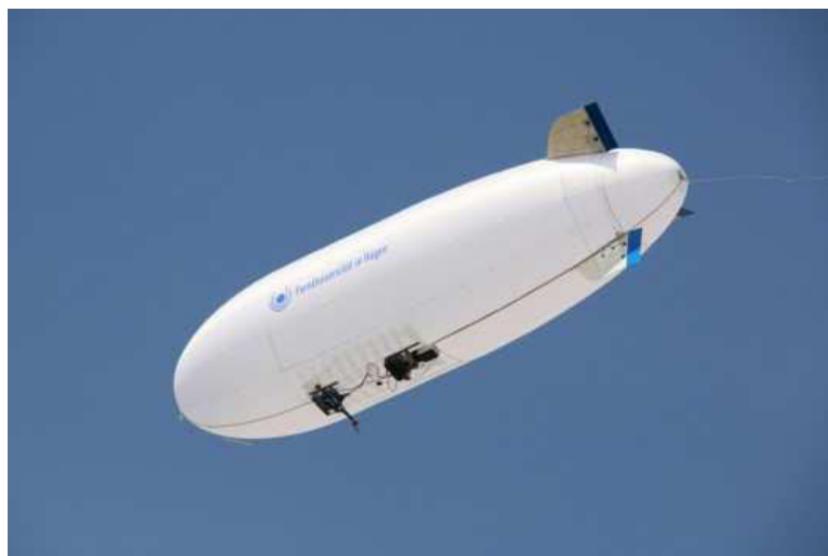
Sl. 16. Radiometrijski senzor na bespilotnom cepelinu [6]
