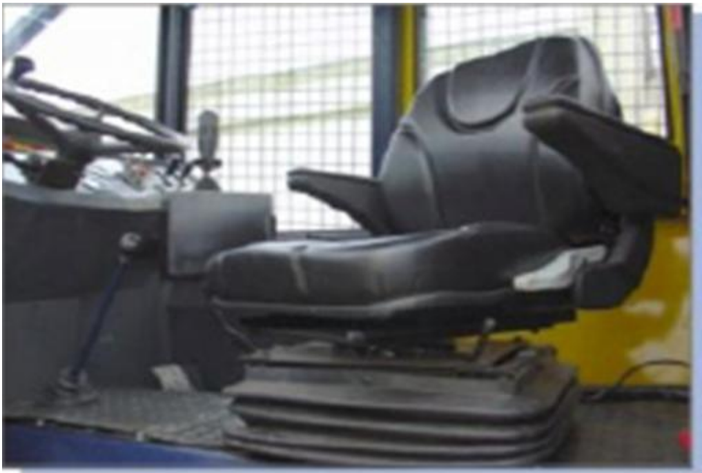
Slika 23. Detalj kabine sa zaštitnim mrežama (pogled iznutra)
