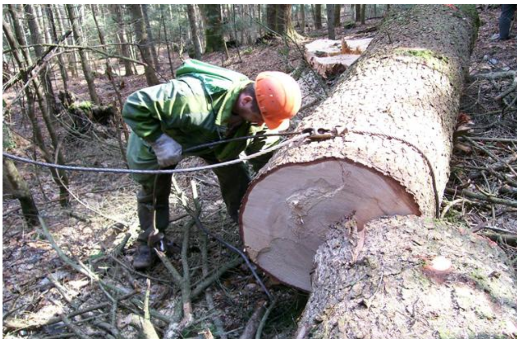
Slika 24. Prikaz ispravnog kopčanja drvnih sortimenata
