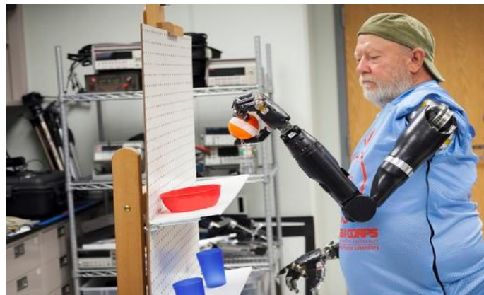
Slika 11. Upravljanje robotskom rukom samo pomoću razmišljanja
