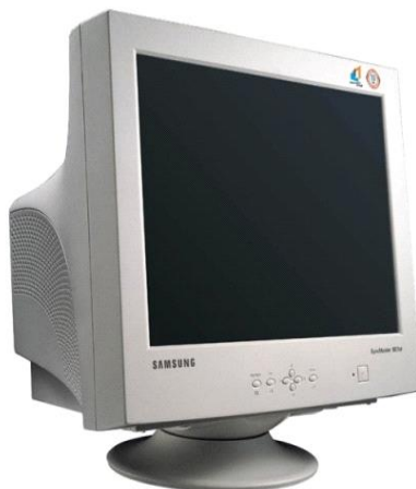
Slika 4. Računalni monitor zasnovan na katodnoj cijevi [15.]
