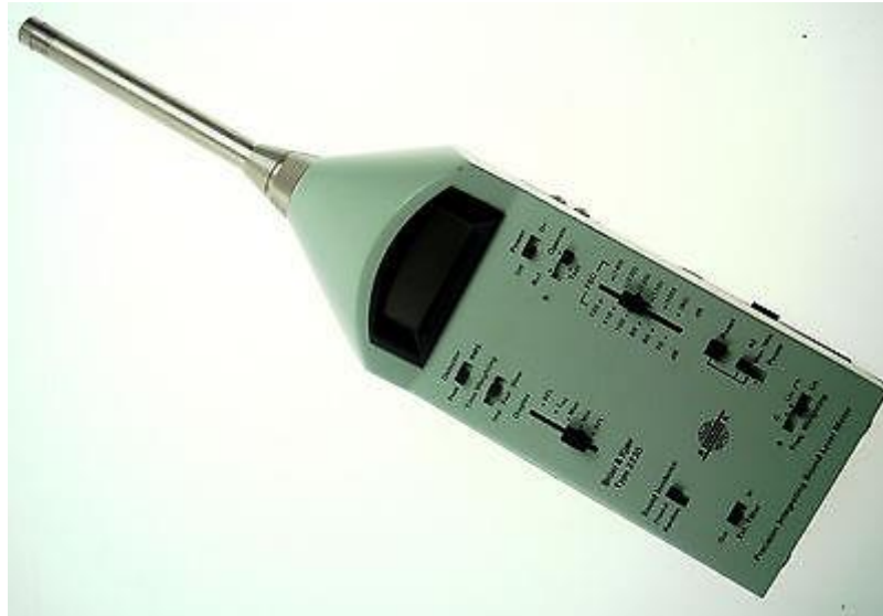
Sl. 18. Instrument za mjerenje buke „ Bruel & Kjeear“
