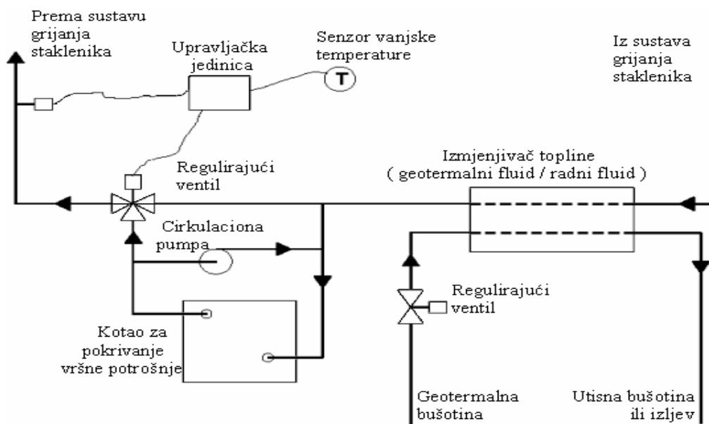
**Slika 28.** Shematski prikaz primjera korištenja geotermalne energije za zagrijavanje staklenika s kotлом za pokrivanje vršne potrošnje.
