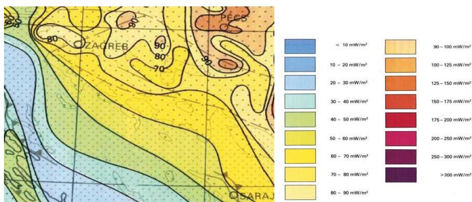
Slika 4. Prikaz gustoće toplinskog toka (mW/m<sup>2</sup>).
