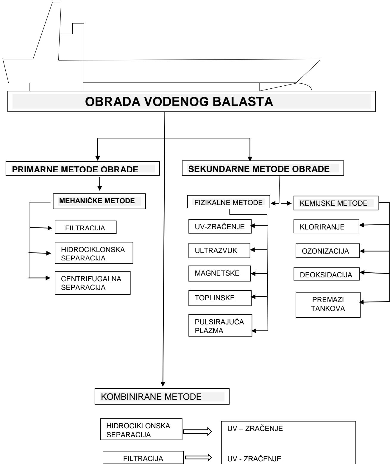
Slika 9. Podjela metoda obrade vodenog balasta na brodu
