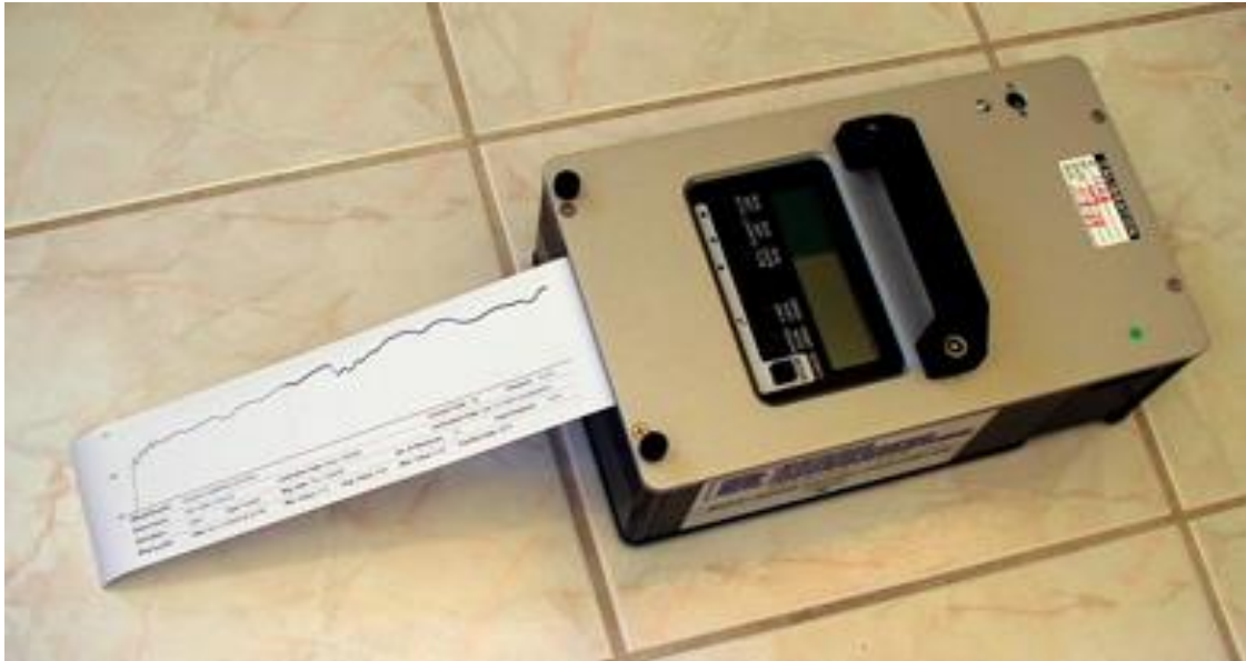
Slika 13. Prikaz tribometra vrste BOT - 3000.
