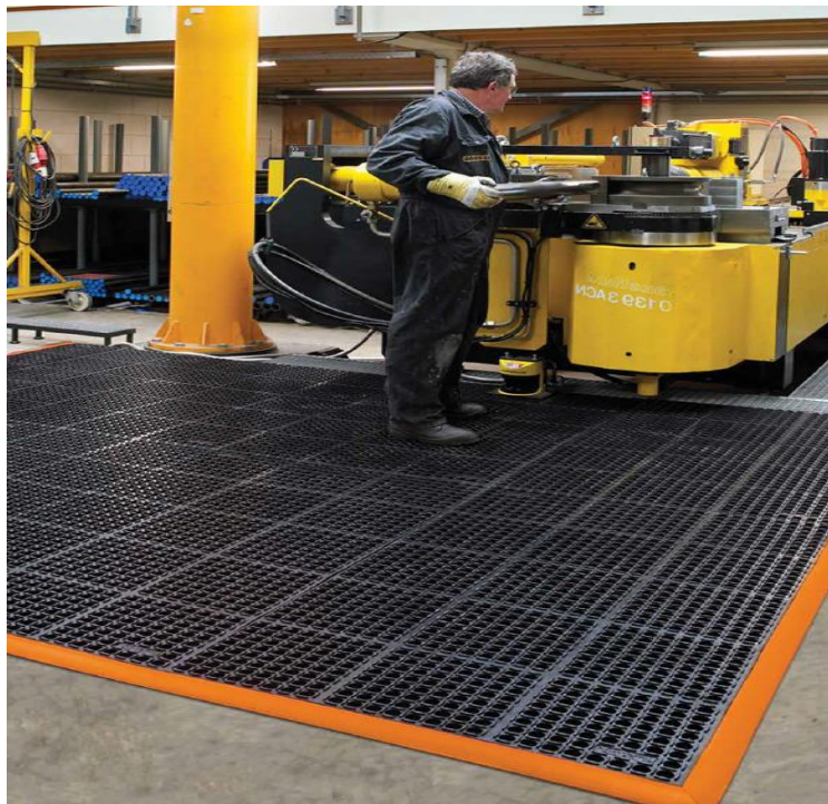
Slika 17. Protuklizna gumena podloga s interlock međusobnim povezivanjem.
