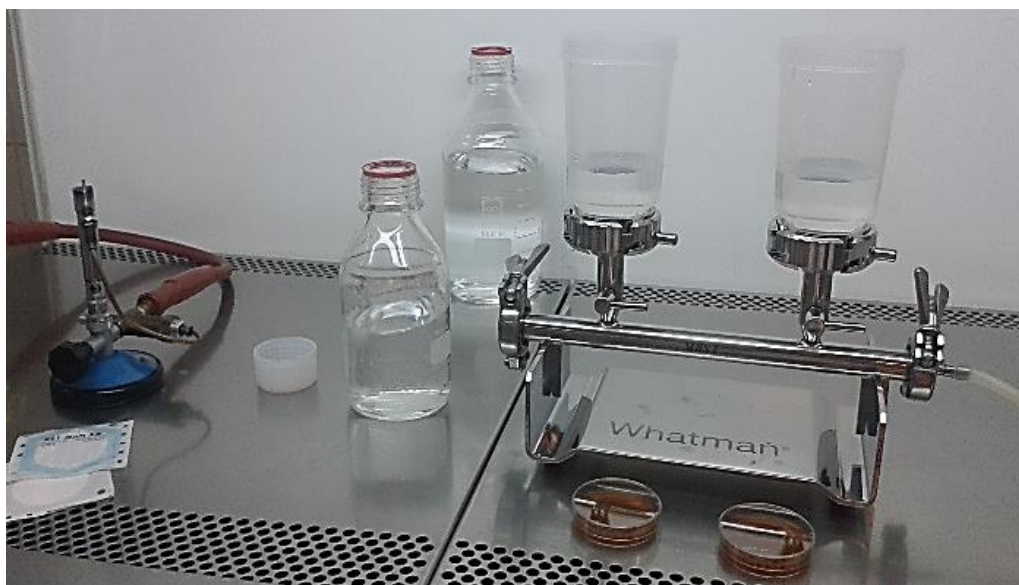
Slika 9. Sistem za membransku filtraciju (Autor: Neda Carević, 21.06.2016.)
