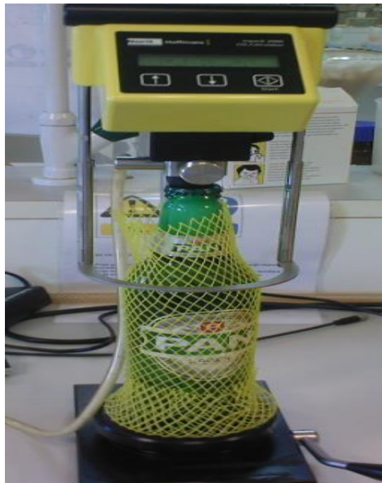
Slika 8. Uređaj za određivanje CO 2 u pivu. Izvor: vlastita fotografija
