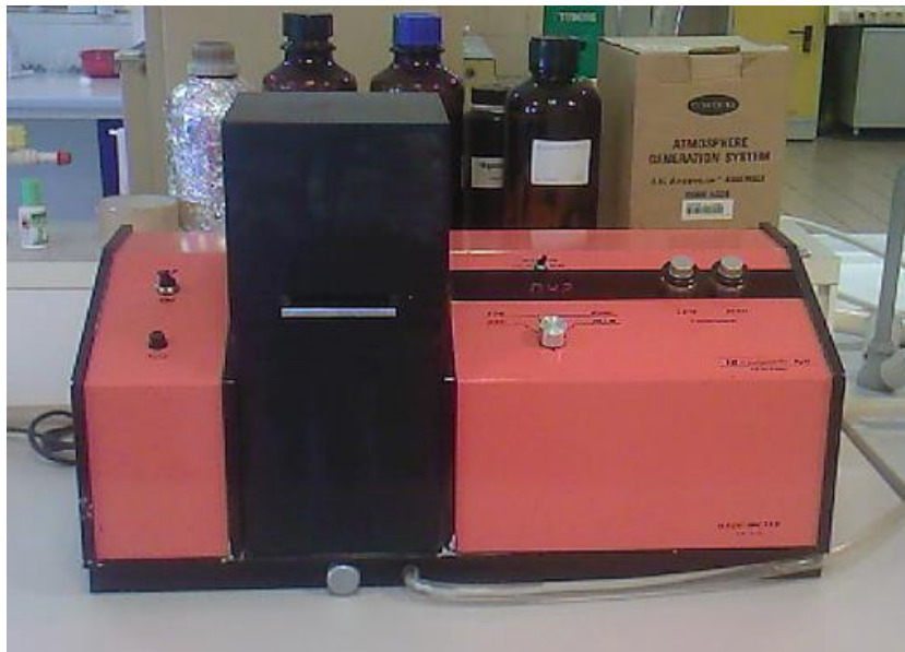
Slika 7. Haze Meter – uređaj za određivanje mutnoće piva. Izvor: vlastita fotografija
