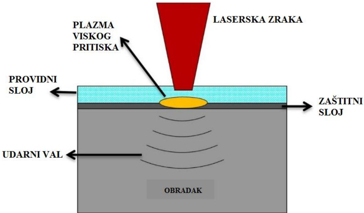
Slika 22. Princip deformacijskog ojačanja materijala
