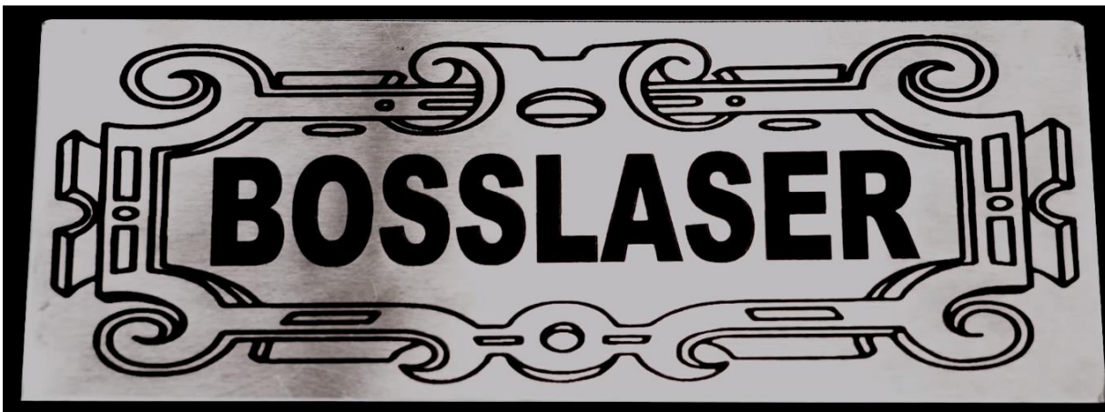
Slika 39. Konačan izgled pločice nakon laserskog markiranja
