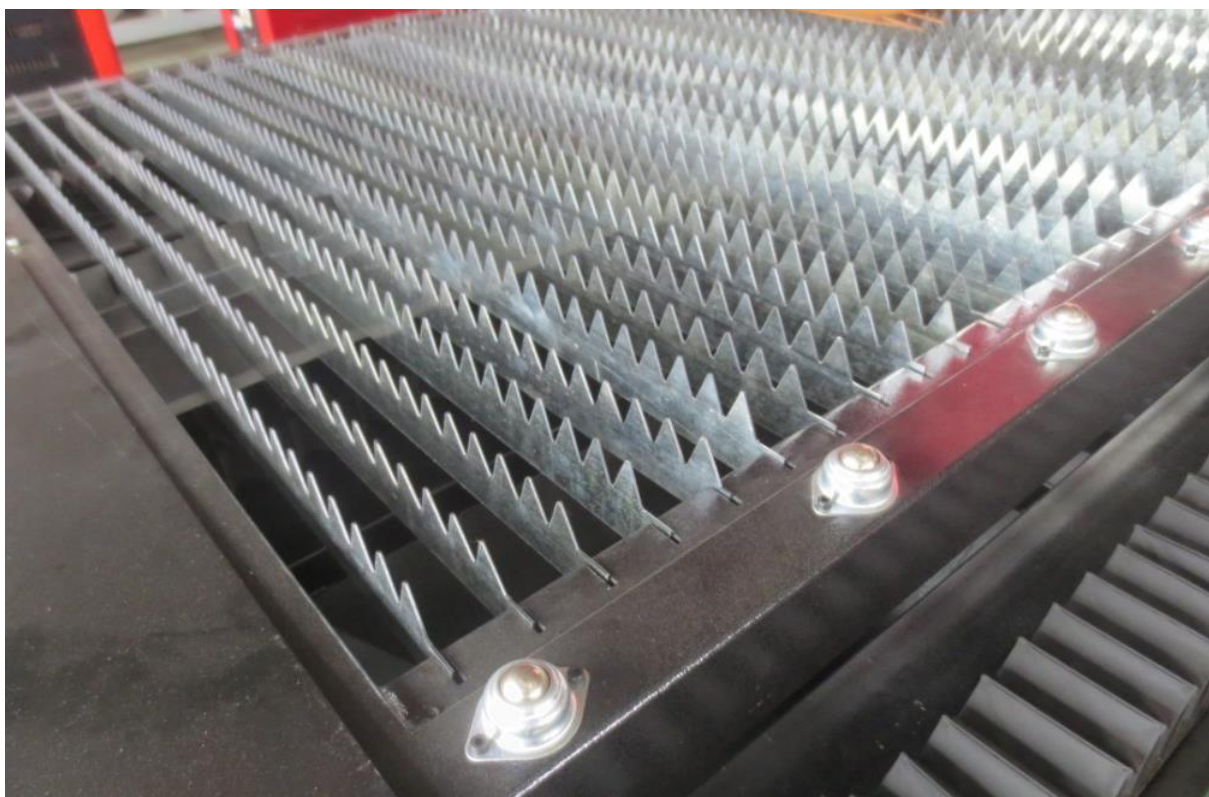
Slika 10. Obradni stol za lasersko rezanje
