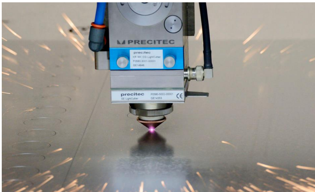
Slika 9. PRETITEC GE-14845 laserska glava u obradi
