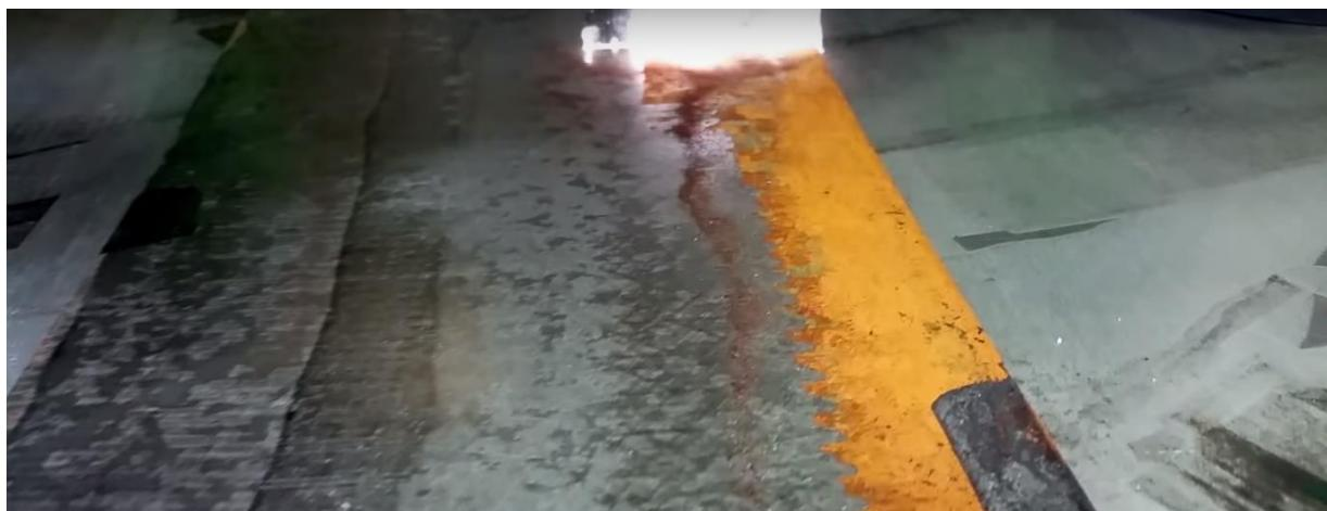
Slika 26. Prikaz površine nakon laserske obrade skidanja korozije
