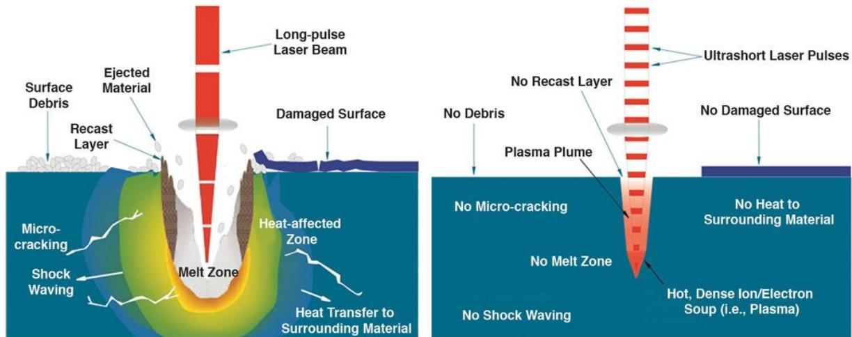
Slika 11. Razlika obrade u odnosu na pulsiranje laserske zrake
