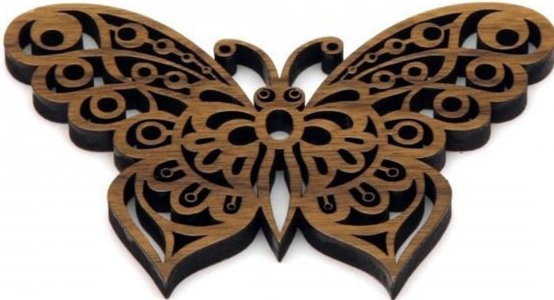
Slika 15. Prmjer laserske obrade sječenjem i prosjecanjem
