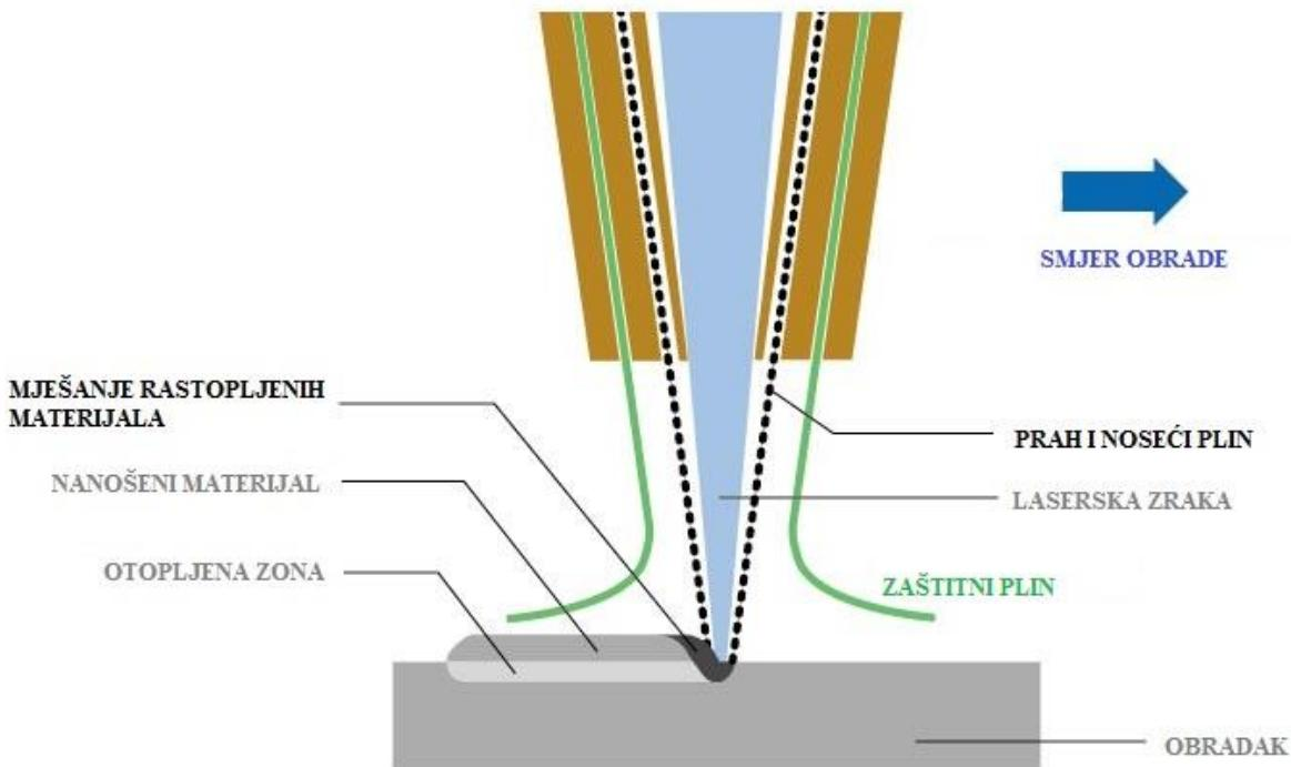
Slika 21. Princip prevlačenja materijala
