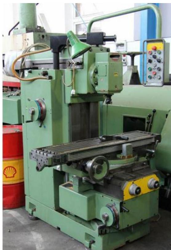
Slika 26. Vertikalna glodalica
