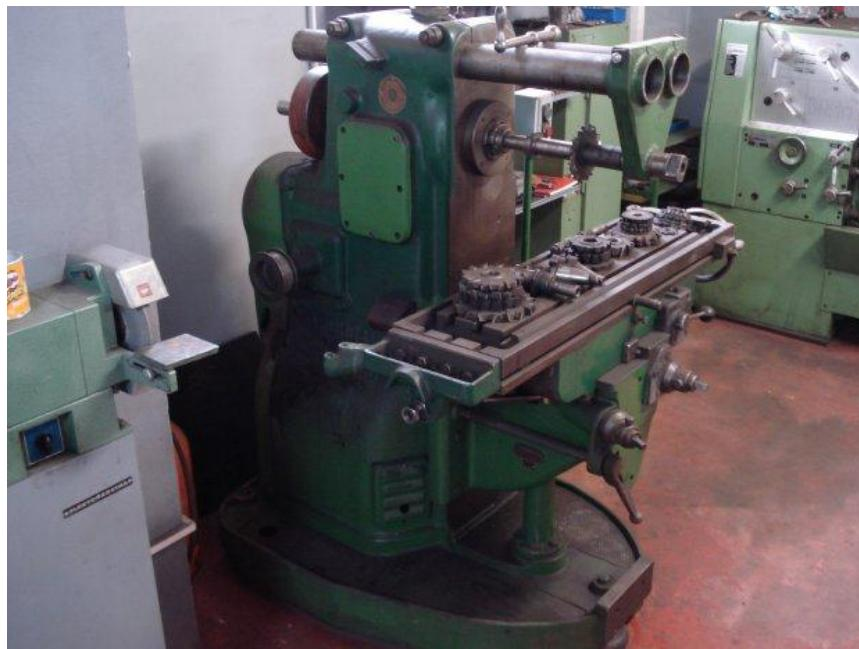
Slika 25. Horizontalna glodalica
