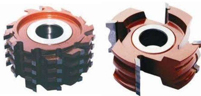
Slika 11. Glodala s lemljenim pločicama
