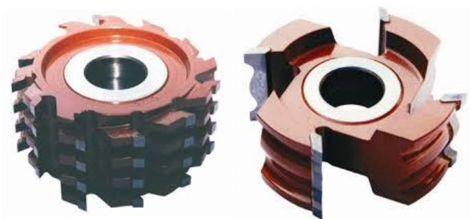
Slika 11. Glodala s lemljenim pločicama
