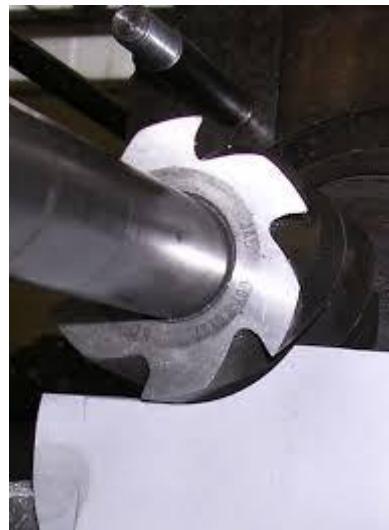
Slika 5. Istosmjerno glodanje
