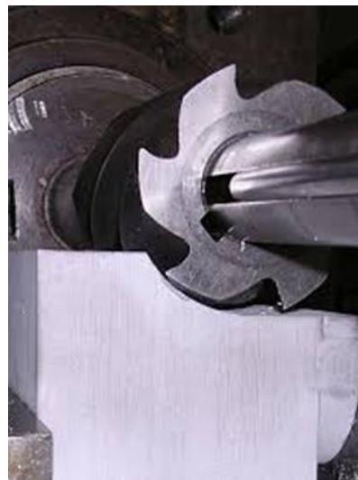
Slika 6. Protusmjerno glodanje
