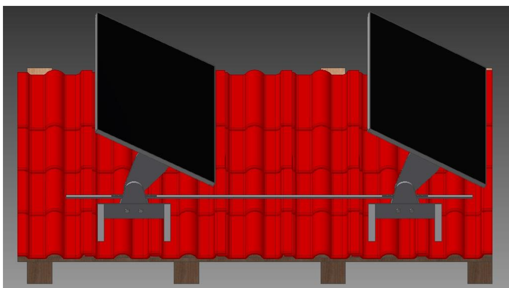
Slika 24. Predodžba zakreta solarnog sustava za 30° (izvorno)
