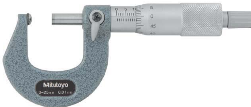
Slika 25. Mikrometar za mjerenja debljine stjenke
