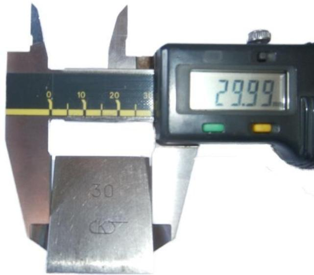
**Slika 44.** Treće mjerjenje etalona od 30 mm
