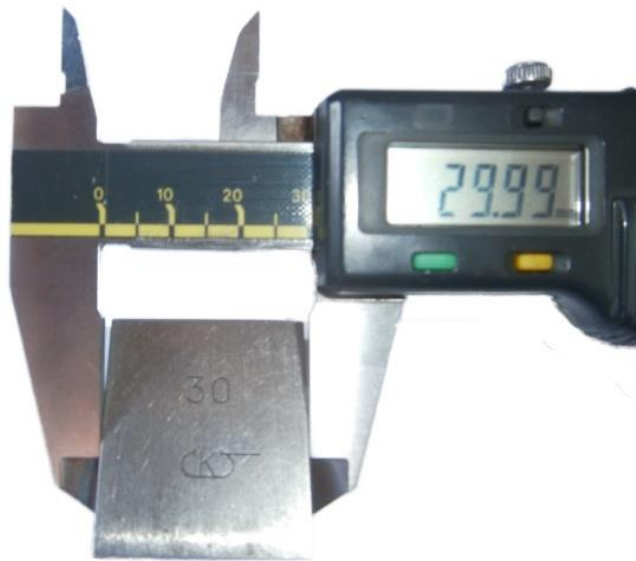
Slika 44. Treće mjerenje etalona od 30 mm
