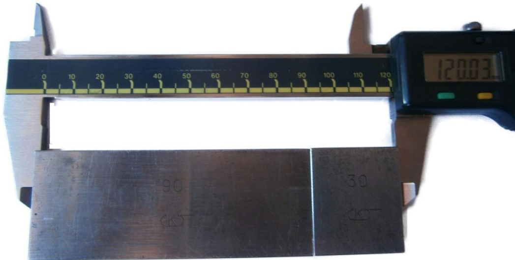
Slika 46. Mjerenje etalona od 120 mm
