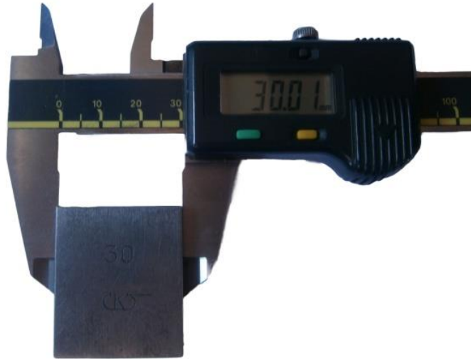
Slika 42. Prvo mjerenje etalona od 30 mm
