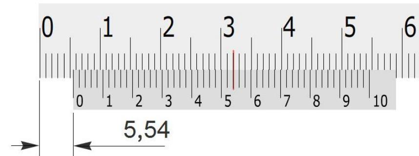
**Slika 16.** Očitanja na klasičnom pomičnom mjerilu rezolucije 0,02 mm [3]
