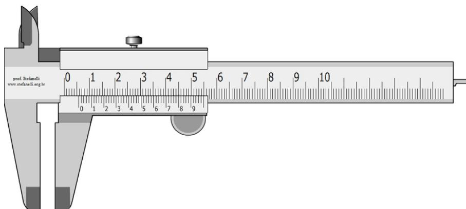
**Slika 13.** Pomično mjerilo s rezolucijom očitanja 0,025 mm [3]
