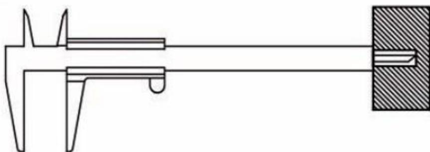
**Slika 19.** Određivanje mjerne pogreške kod mjerena dubine
