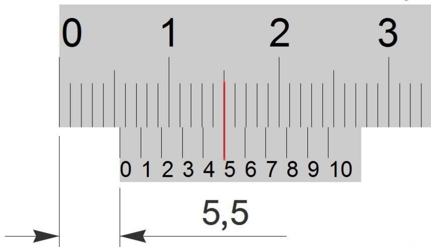
**Slika 14.** Očitanja na klasičnom pomičnom mjerilu rezolucije 0,1 mm [3]
