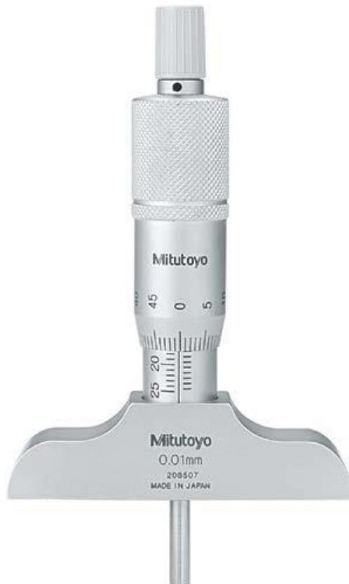
**Slika 28.** Mikrometar za mjerjenje dubine
