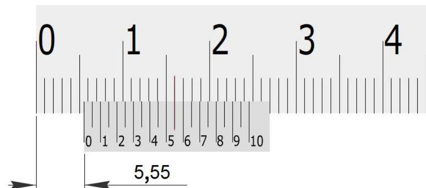
**Slika 15.** Očitanja na klasičnom pomičnom mjerilu rezolucije 0,05 mm [3]
