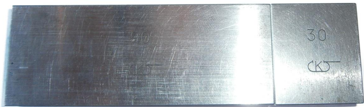
Slika 45. Spajanje dvaju etalona 120 mm
