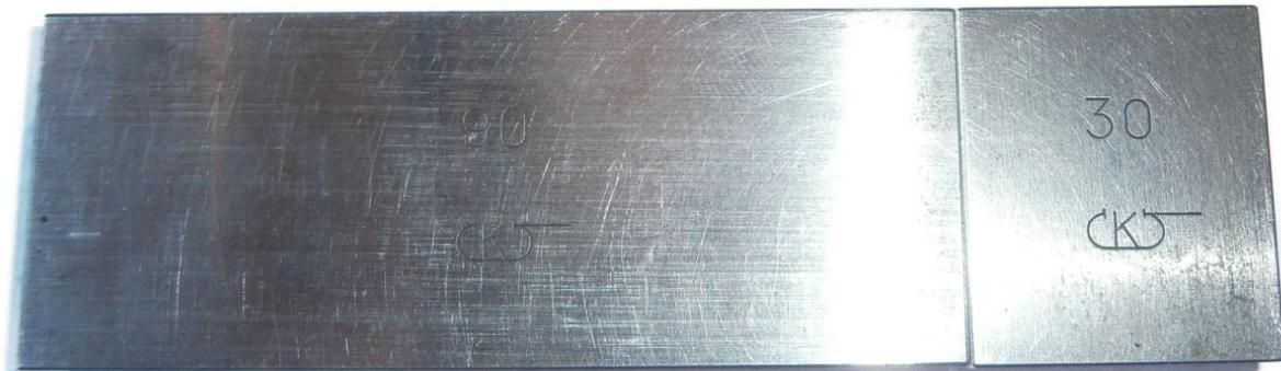
**Slika 45.** Spajanje dvaju etalona 120 mm
