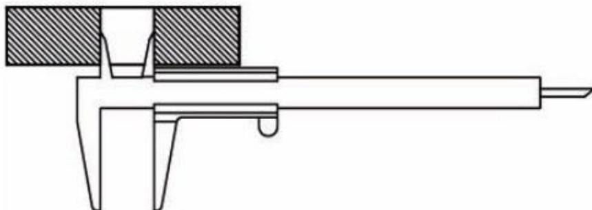
**Slika 18.** Određivanje mjerne pogreške kod mjerena šiljcima
