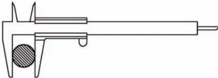
**Slika 17.** Određivanje mjerne pogreške kod mjerena kljunovima
