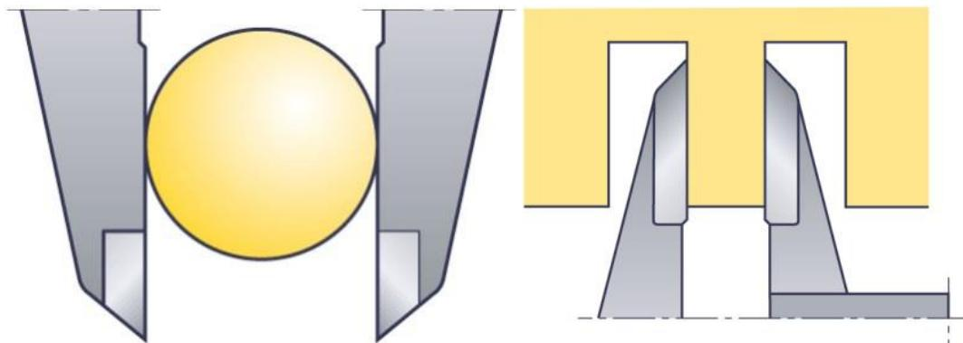
**Slika 8.** Vanjsko mjerjenje
