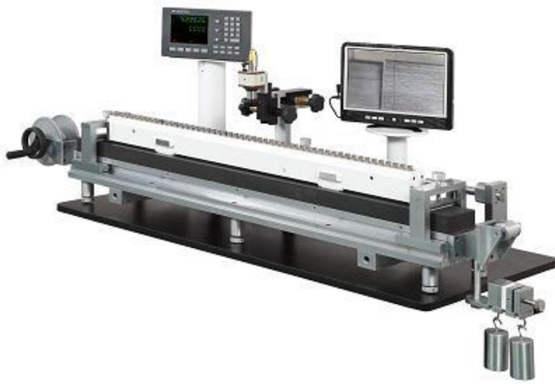
**Slika 38.** Uređaj za umjeravanje mjernih traka
