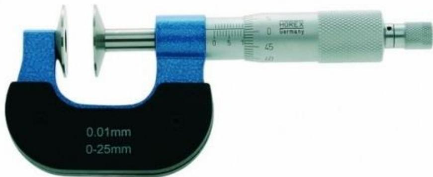
**Slika 27.** Mikrometar za zupčanike [21]
