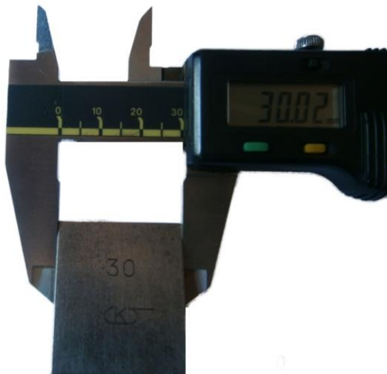
Slika 43. Drugo mjerenje etalona od 30 mm
