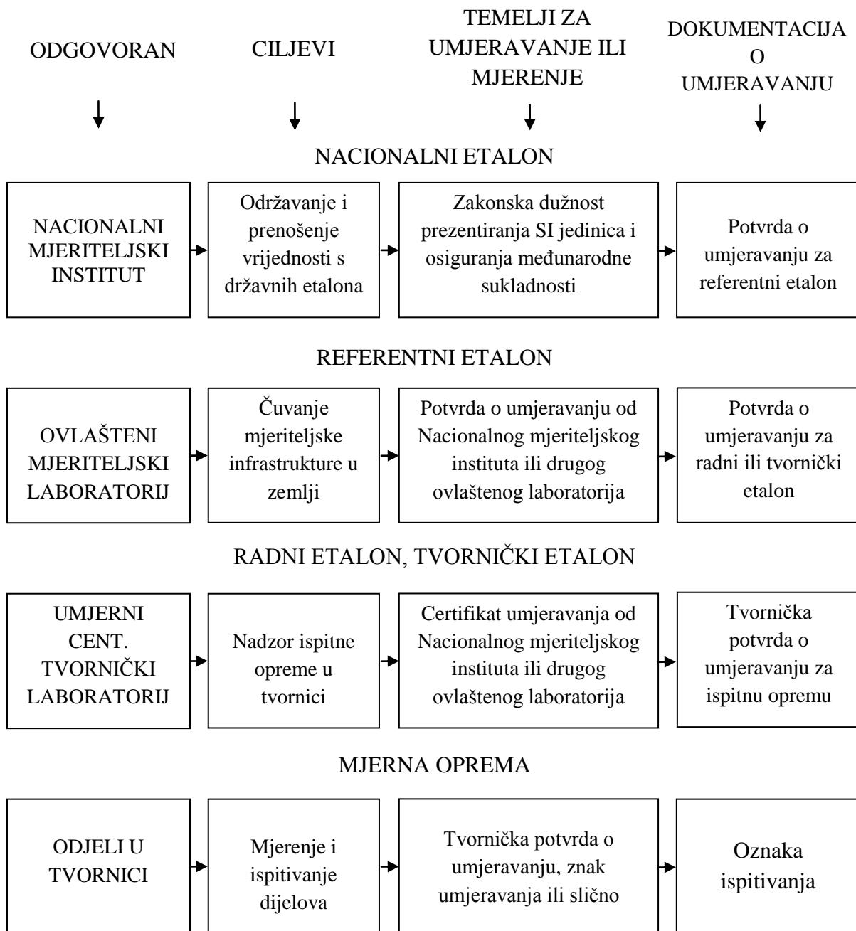
Slika 6. Sljedivost mjerne i ispitne opreme [4]
