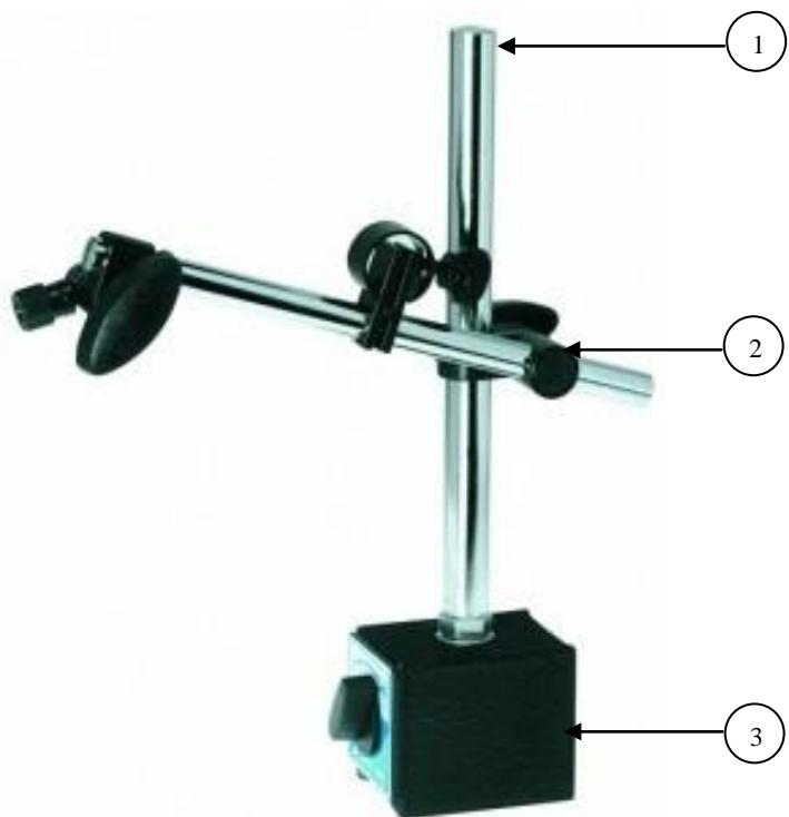
Slika 33. Držač za mjernu uru, magnetni stalak [21]
