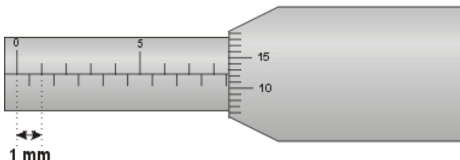
**Slika 23.** Prikaz očitanja na klasičnom mikrometru [3]
