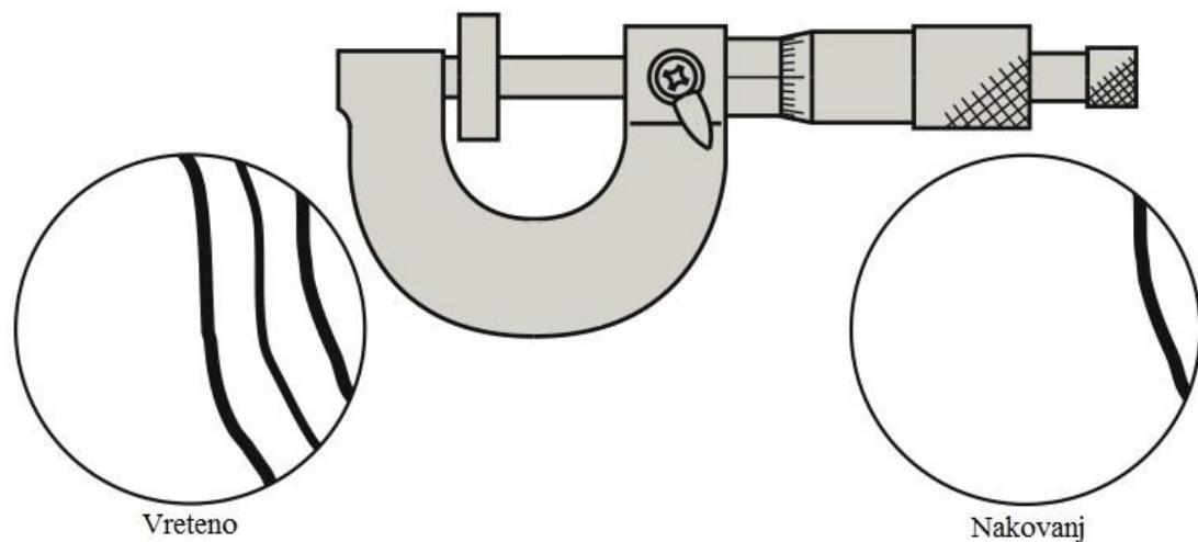
**Slika 29.** Mjerjenje neravnosti mjernih površina
