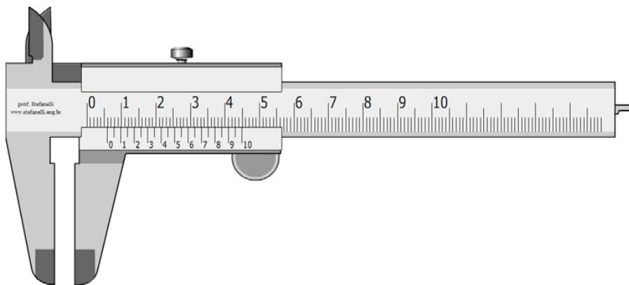
**Slika 12.** Pomično mjerilo s rezolucijom očitanja 0,05 mm [3]
