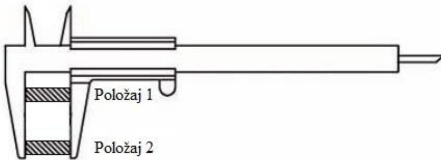
**Slika 21.** Mjerenje neparalelnosti površina za vanjska mjerena
