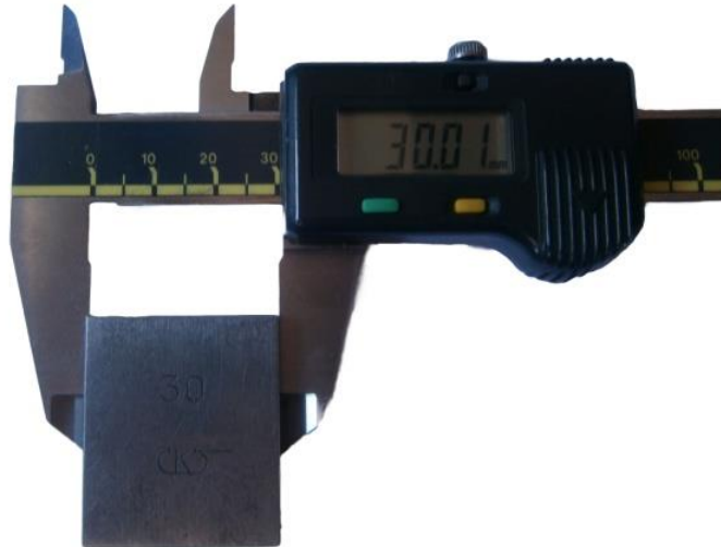
Slika 42. Prvo mjerenje etalona od 30 mm
