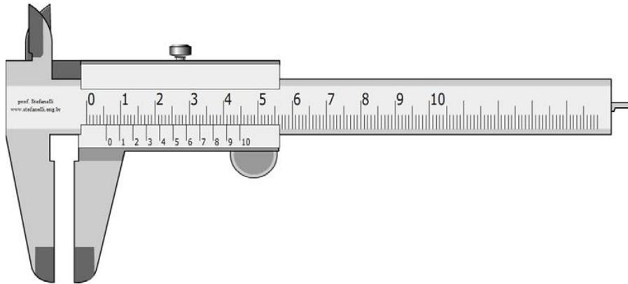
**Slika 11.** Pomično mjerilo s rezolucijom očitanja 0,1 mm [3]
