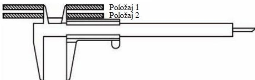
**Slika 20.** Mjerenje neparalelnosti površina za unutarnja mjerena
