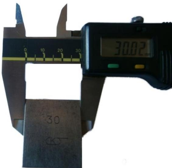
**Slika 43.** Drugo mjerjenje etalona od 30 mm
