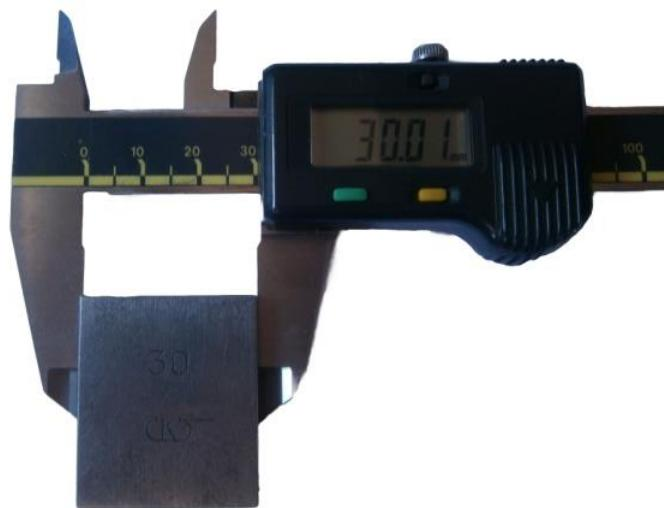
**Slika 42.** Prvo mjerjenje etalona od 30 mm
