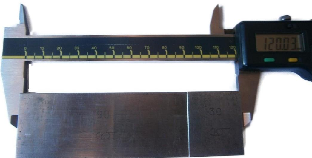
**Slika 46.** Mjerenje etalona od 120 mm
