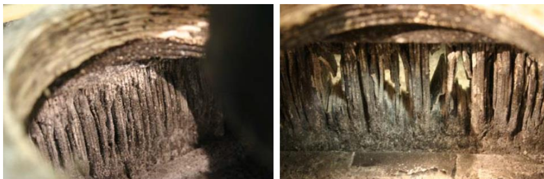
Slika 35: Metalne pločice hvatača plamena (iznutra) [20].
