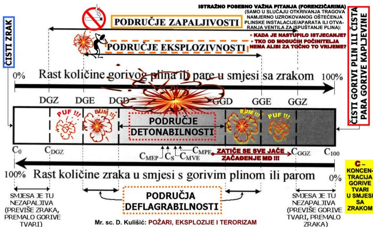
Slika 3: Područje zapaljivosti, eksplozivnosti, deflagrabilnosti i detonabilnosti [11].
