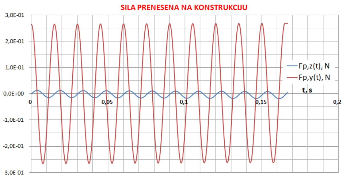
Slika 49. Graf sila prenesene na konstrukciju
