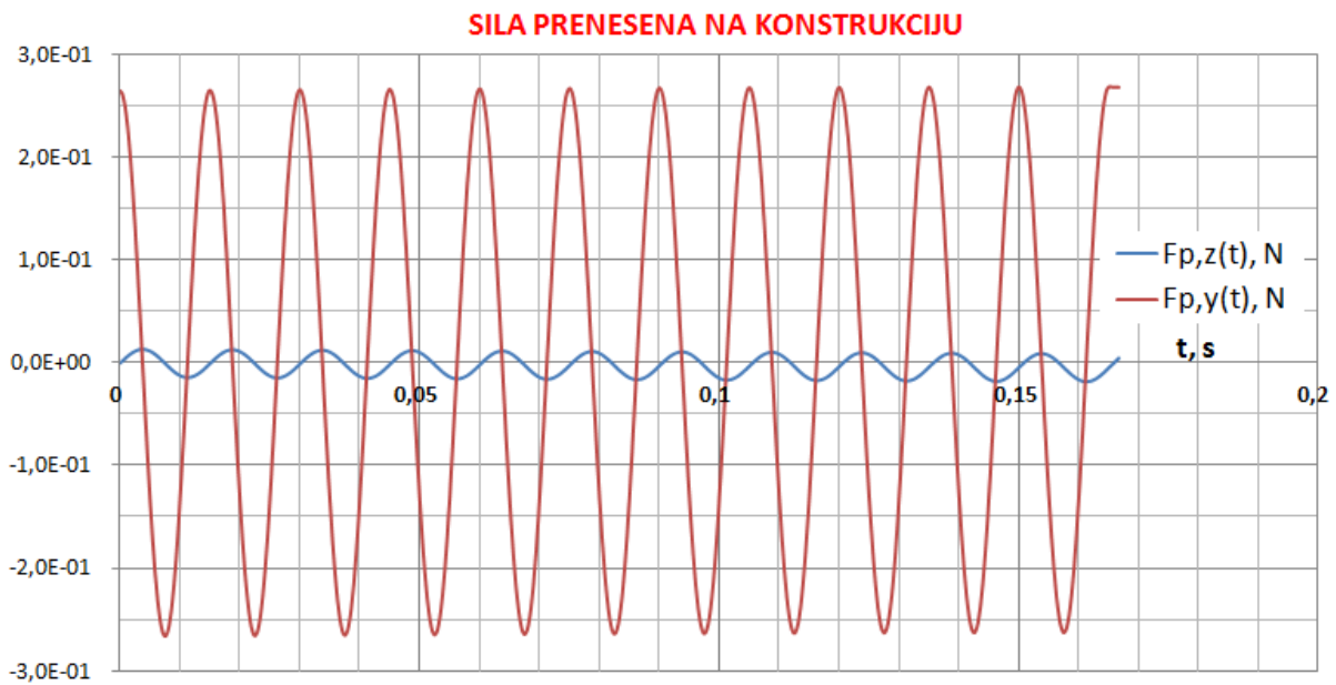
Slika 49. Graf sila prenesene na konstrukciju
