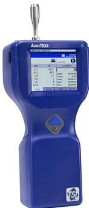
Slika 13. Predodžba laserskog brojača čestica (LPC)
