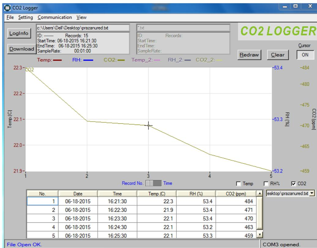
Slika 20. Predodžba izmjerene vrijednosti CO<sub>2</sub> u praznom uredu
