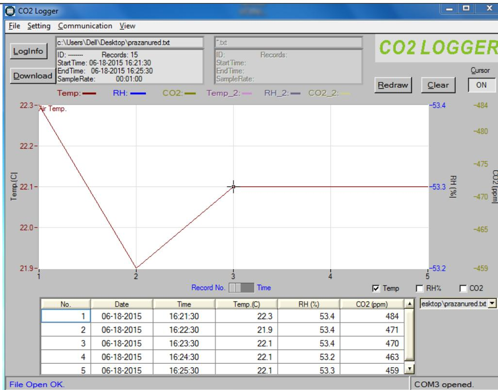
Slika 21. Predodžba izmjerene temperature u praznom uredu
