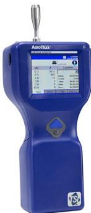
Slika 13. Predodžba laserskog brojača čestica (LPC)
