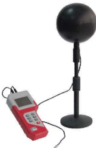
Slika 2. Predodžba globus termometra
