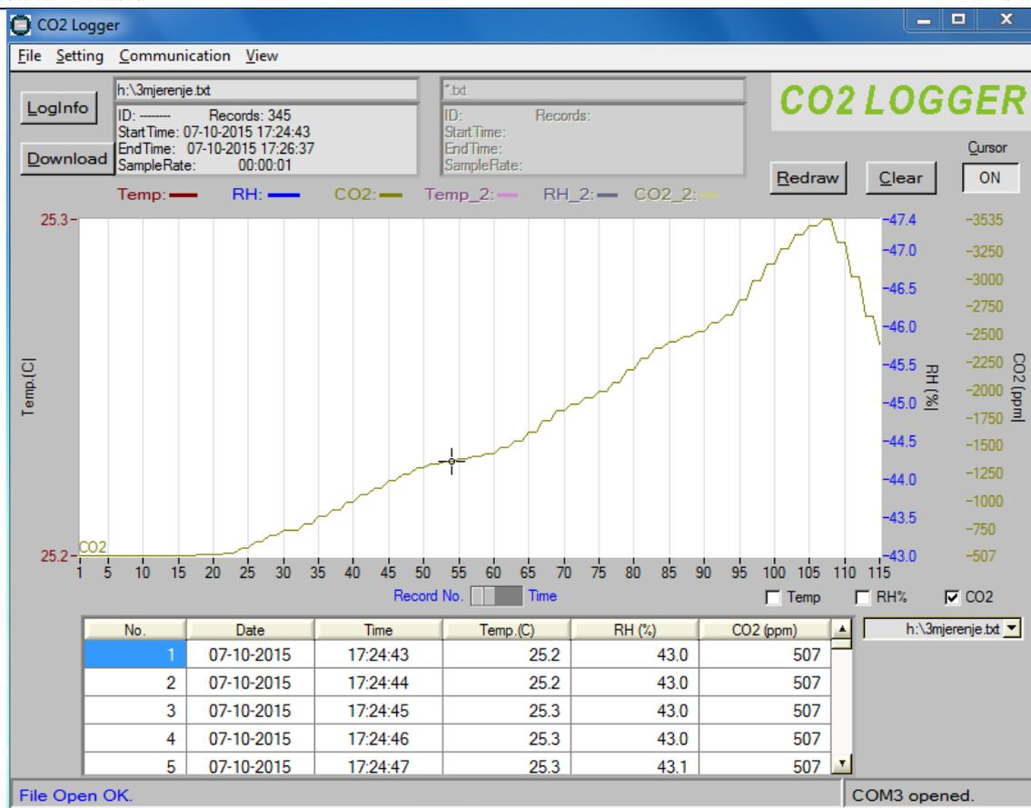
Slika 26. Predodžba izmjerene brzine zasićenja CO2 u prostoru
