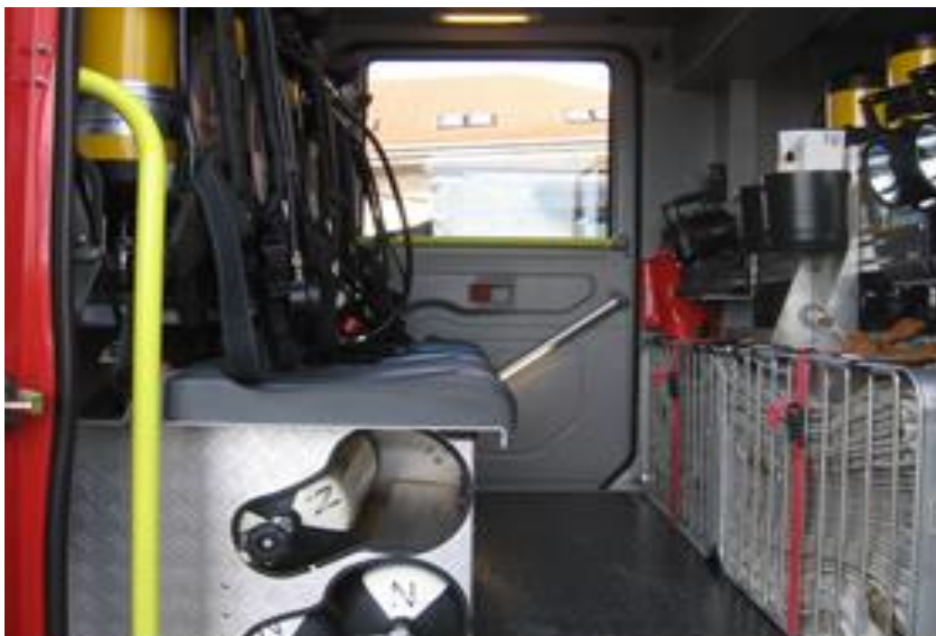
Sl. 4. Unutrašnjost navalnog vozila sa integriranim nosačima IA sa stlačenim zrakom u naslonima sjedala [6]
