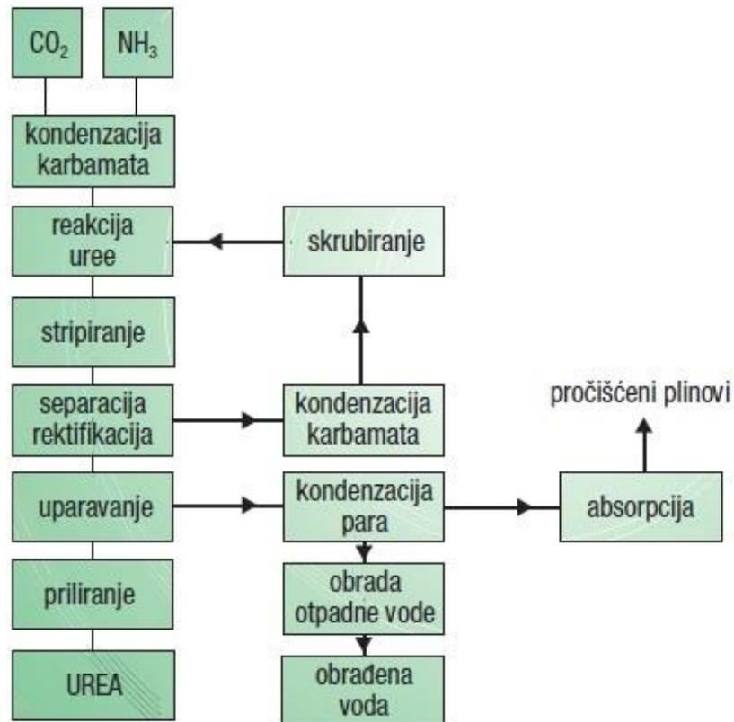
Slika 5.: Procesna shema CO<sub>2</sub> stripping procesa proizvodnje uree [3]
