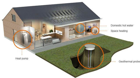
Slika 2. Prikaz korištenja geotermalne energije u kućanstvu
