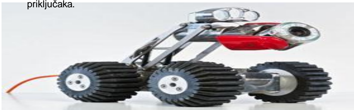
SI. 11. Robot za pregled cijevi [3], [6]
