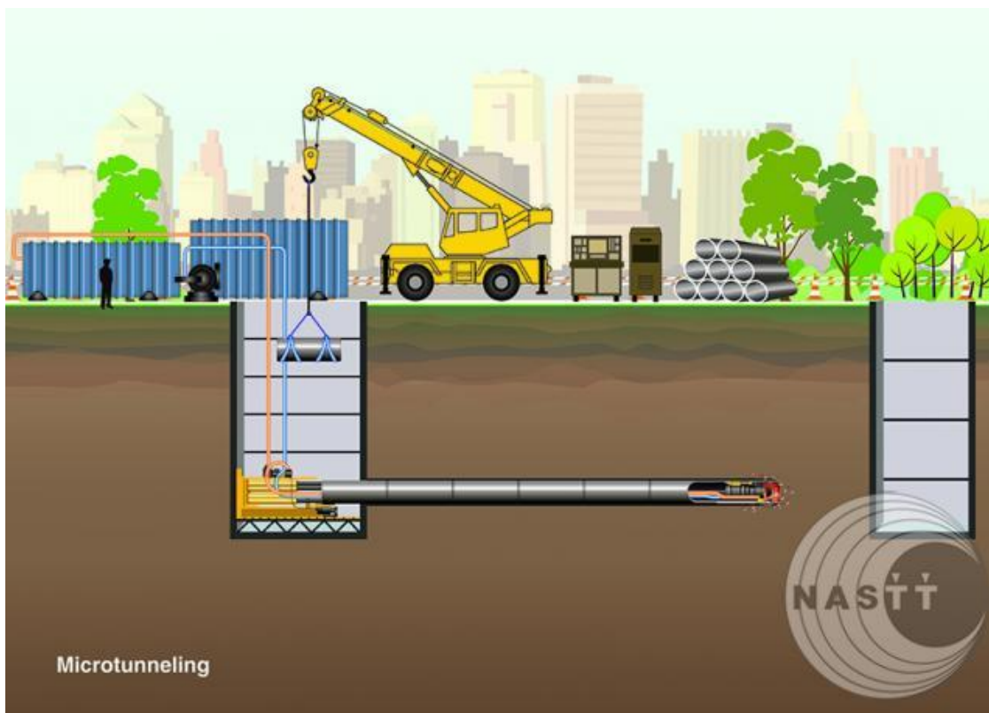
SI. 18. Strojni iskop punog profila [3]
