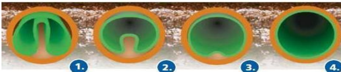
SI. 6. Ugradnja nove cijevi [3]
