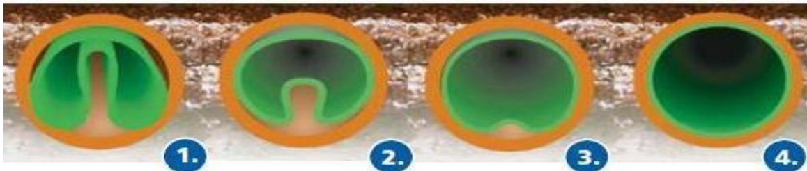
SI. 6. Ugradnja nove cijevi [3]
