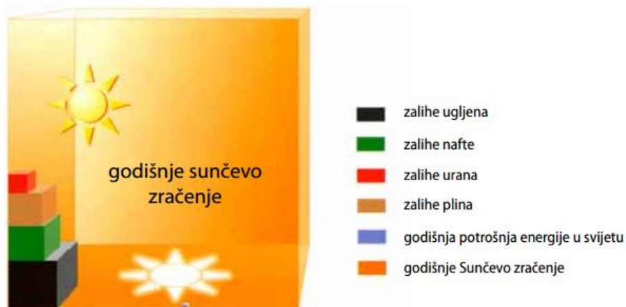
Slika 1.1.: Godišnje sunčevo zračenje na površini Zemlje u usporedbi sa zalihama fosilnih i nuklearnih goriva i godišnjom potrošnjom energije u svijetu [6]
